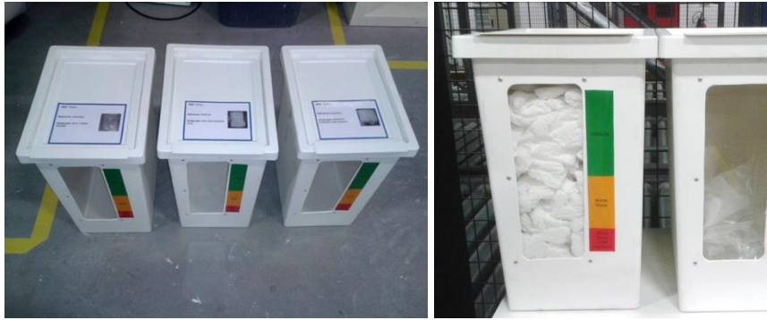
Figura 44: Contentores de material consumível com indicador de nível de stock .
