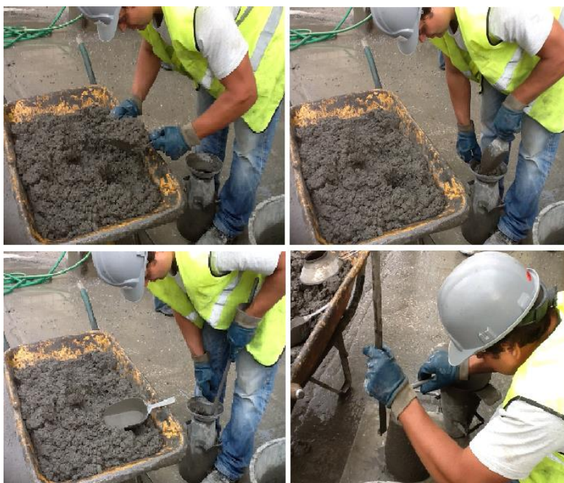
Figura 4.42 - Ensaio de abaixamento.
