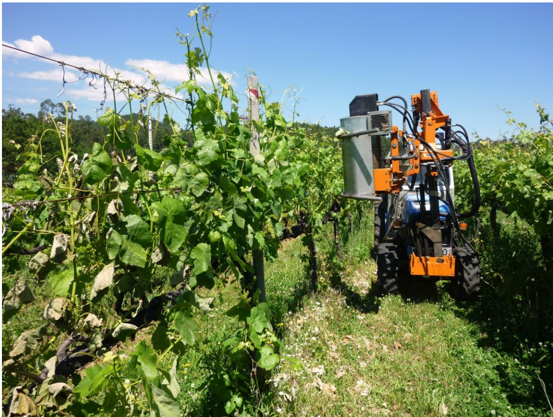
FIGURA 5 - MÁQUINA DE DESFOLHA LR350 PROVITIS. LOUREIRO, EVAG, 2014
