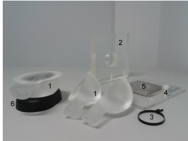
Fig. 3.8 – Elementos do fantoma construído. 1: partes da esfera; 2: suporte; 3: anilha para junção das partes da esfera; 4: parafusos de nivelção; 5: peso adicional; 6: suporte para posicionamento das partes da esfera.
