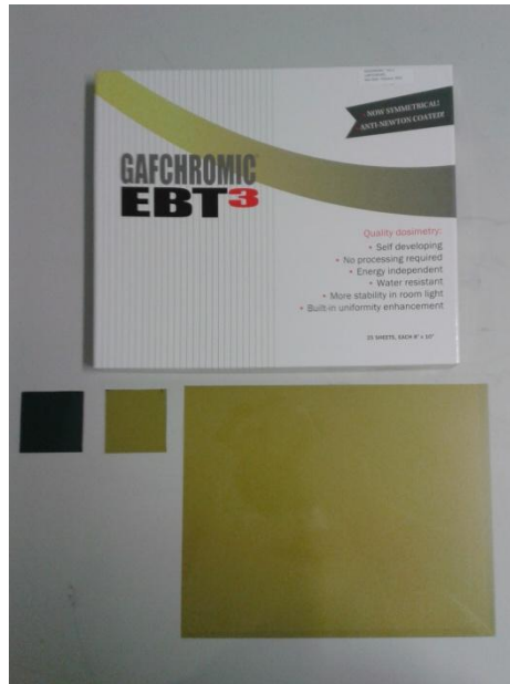
Fig. 2.7 – Amostra de filme Gafchromic EBT3 irradiada, não irradiada e filme original.
