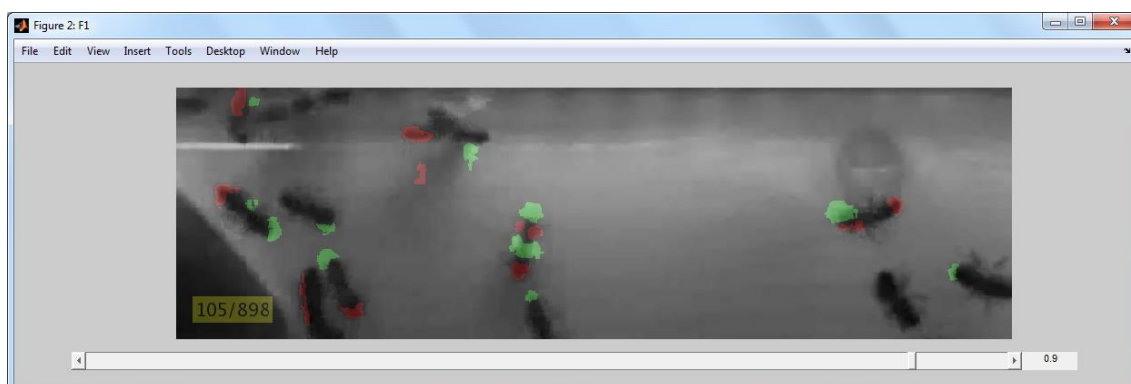
Figura 16 – Aspeto visual da execução do script de auxílio ao processo de contagem manual de entradas e saídas da colónia, com previsão de trajetos (a verde) e identificação de trajetórias executadas (a vermelho)
