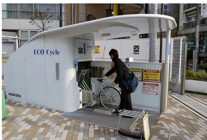
Fig. 3.22. - Eco Cycle. Estacionamento automatizado e subterrâneo para bicicletas que permitem que os ciclistas as guardem desde o nível da rua, sem medo de não encontrar a sua bicicleta quando voltarem
