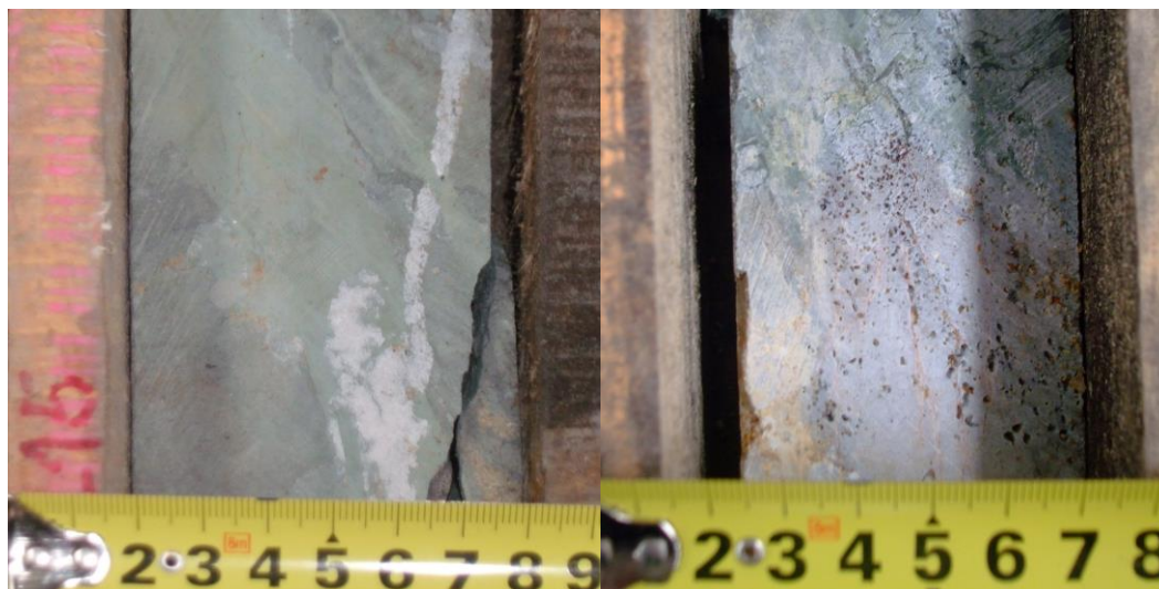
Figura 25: Alteração sob a forma de oxidação e cloritização, e raramente silicificação e carbonatação
