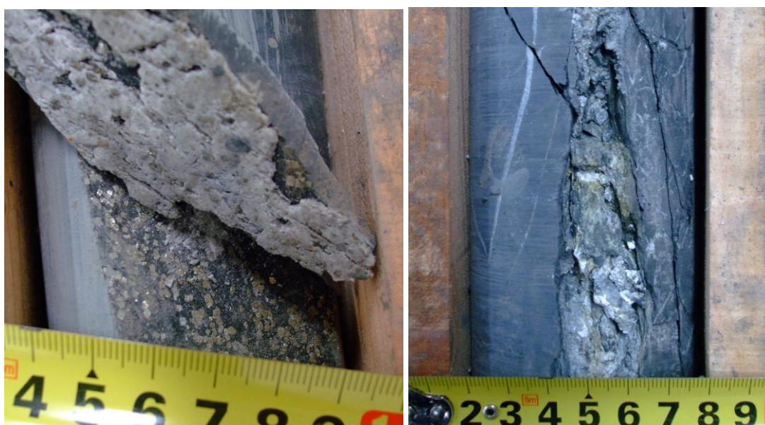
Figura 32: Filonete de quartzo, com pirite neste e no encaixante (esquerda) e zona de esmagamento (direita)
