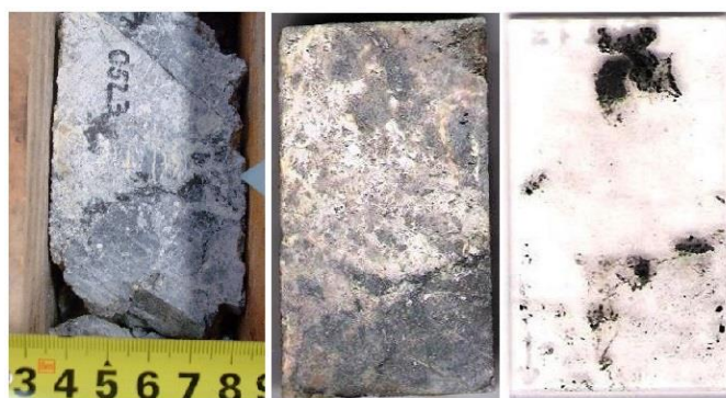
Figura 63: Amostra LBJ13 referente a zona de esmagamento com argila, carbonatos e óxidos e pequenos fragmentos do encaixante constituído por níveis negros ferríferos - LBJ13
