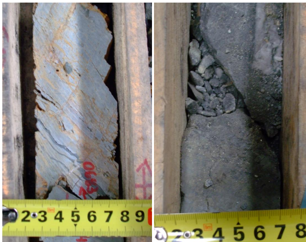
Figura 87: Redes de filonetes com preenchimento de quartzo com alteração em oxidação e argilização (esquerda) e nível com pirite ( \text{FeS}_2 ) que é a espécie mineral com maior representação (direita).
