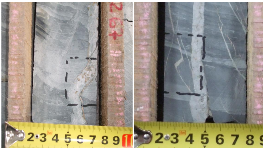
Figura 86: Filonetes e redes de filonetes de quartzo, bastante irregulares, com inclinações verticais a subverticais e estratificação em geral pouco inclinada, mais ou menos perturbada (amostras referentes à sondagem BS1212A)
