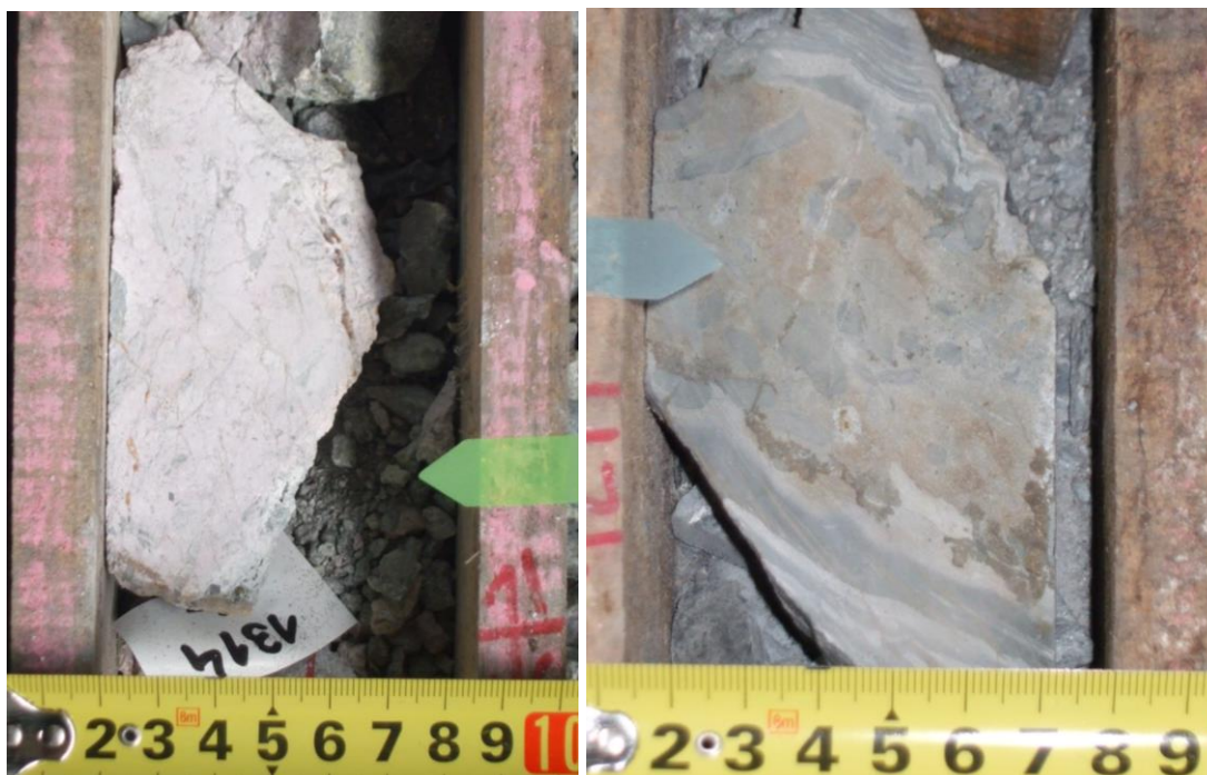
Figura 83: Nível de anortite, referente à sondagem (esquerda) e nível com clastos lingulídeos (direita), referentes à sondagem BS1212A
