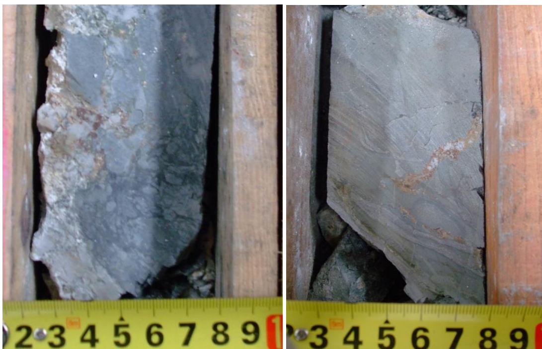
Figura 31: Nível com bioturbação e argilização (a esquerda) e nível com cloritização e oxidação (a direita)
