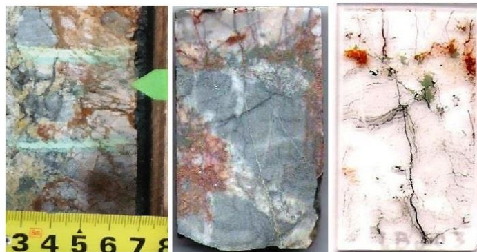
Figura 47: Amostra LBJ03 referente a zona brechificada com matriz de óxidos e fragmentos do encaixante.
