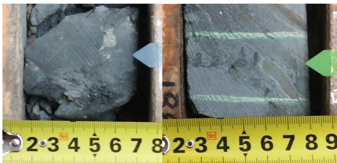
Figura 26: Níveis negros ferríferos (a esquerda) e níveis fosfatados que contêm lingulídeos (a direita).
