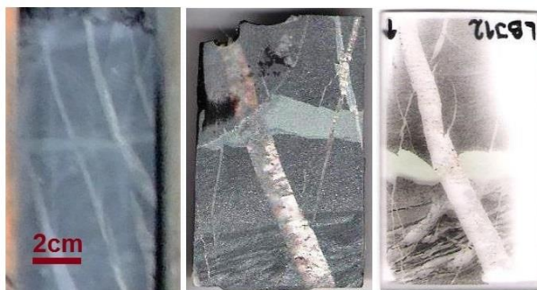
Figura 65: Amostra LBJ12 referente a zona com filonetes preenchidos por argilas, carbonatos e óxidos em de alternâncias de níveis xisto-quartzíticos e níveis negros ferríferos.
