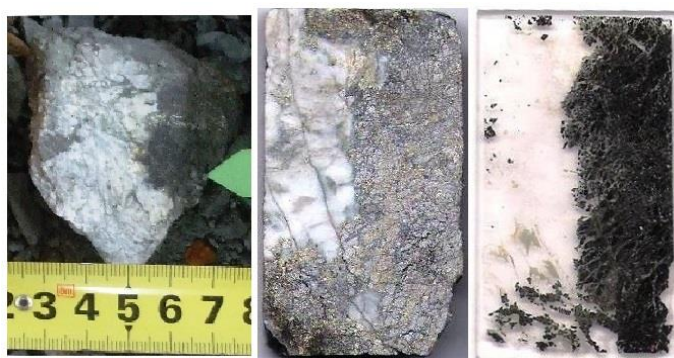
Figura 42: Amostra LBJ05 referente aos níveis ferríferos em contacto com filonete (?) de quartzo
