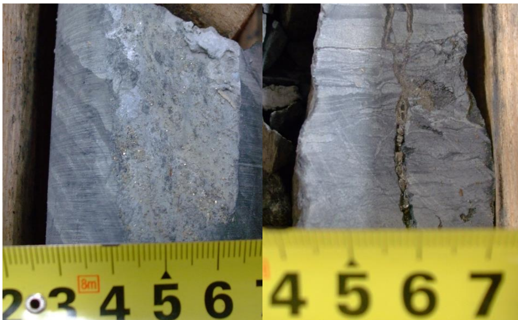
Figura 29: Pirite é a espécie mineral com maior representação, apresentando-se sob a de cristais, aparecendo na rocha encaixante (esquerda) ou em filonetes (direita)
