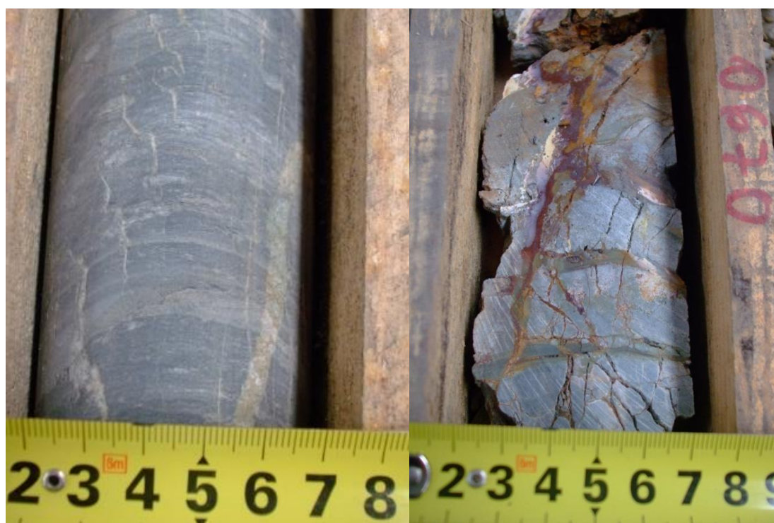
Figura 27: Filões a preencher fracturas com preenchimento por quartzo leitoso, (esquerda) e brecha numa matriz de óxidos, argila e clorite (direita)
