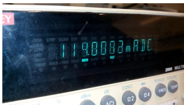
Figura A3.5: Amostra da corrente no arranque da versão 1.
