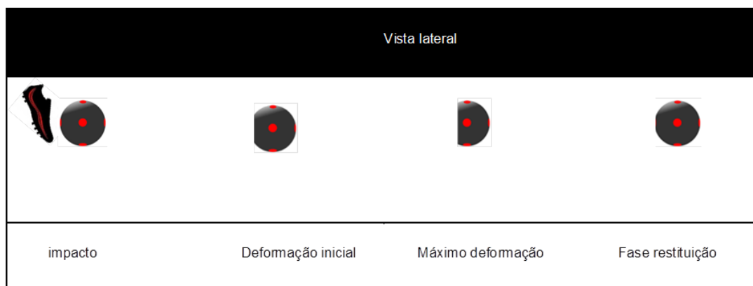
Figura 7 – A deformação causada por forças horizontais
