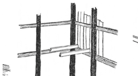
[4c]. Estrutura de um palheiro do “Tipo de Vieira”.
