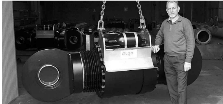
Fig. 1.23: Amortecedor instalado na ponte Carquinez, São Francisco
