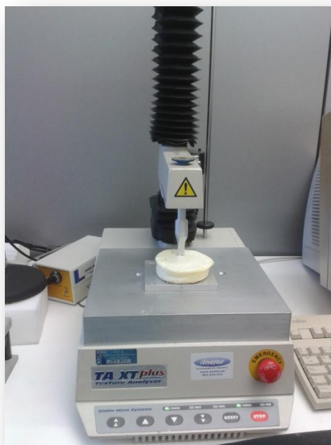
Figura 9. Ensaio de penetração com dente com o uso da sonda “Voled Jaws”
