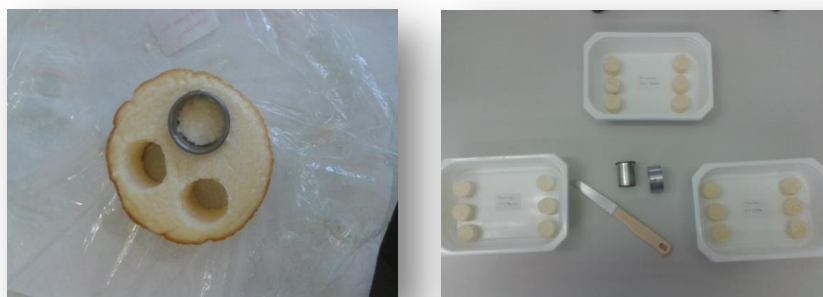
Figura 6. Recolha de três amostras diferentes de cada tarte com o auxílio de um cilindro
