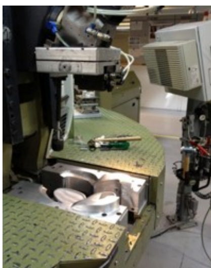
Figura 29 - Estação da máquina de injeção.
