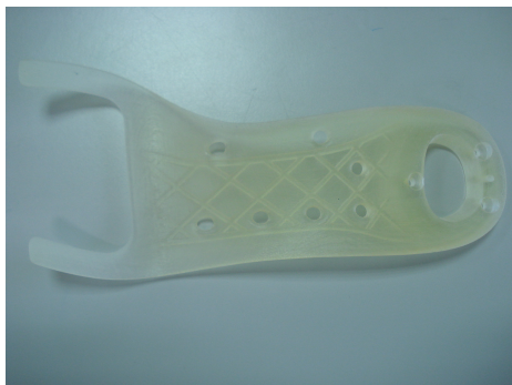
Figura 23 - Shank impresso em resina.
