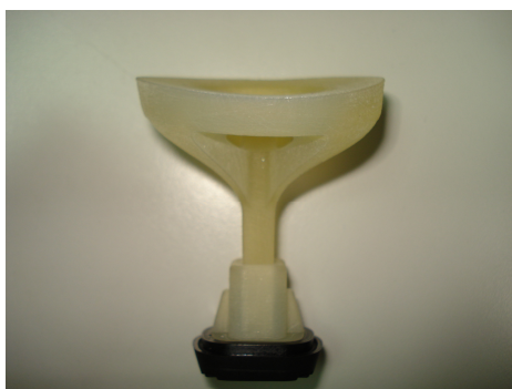
Figura 24 - Estrutura de suporte do tacão impressa em resina.
