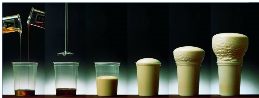
Figura 2 - Expansão do PU [2].
