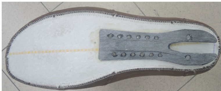
Figura 14 - Colocação de shank num sapato
