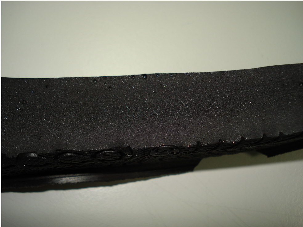
Figura 3 - Interior de uma sola de PU.
