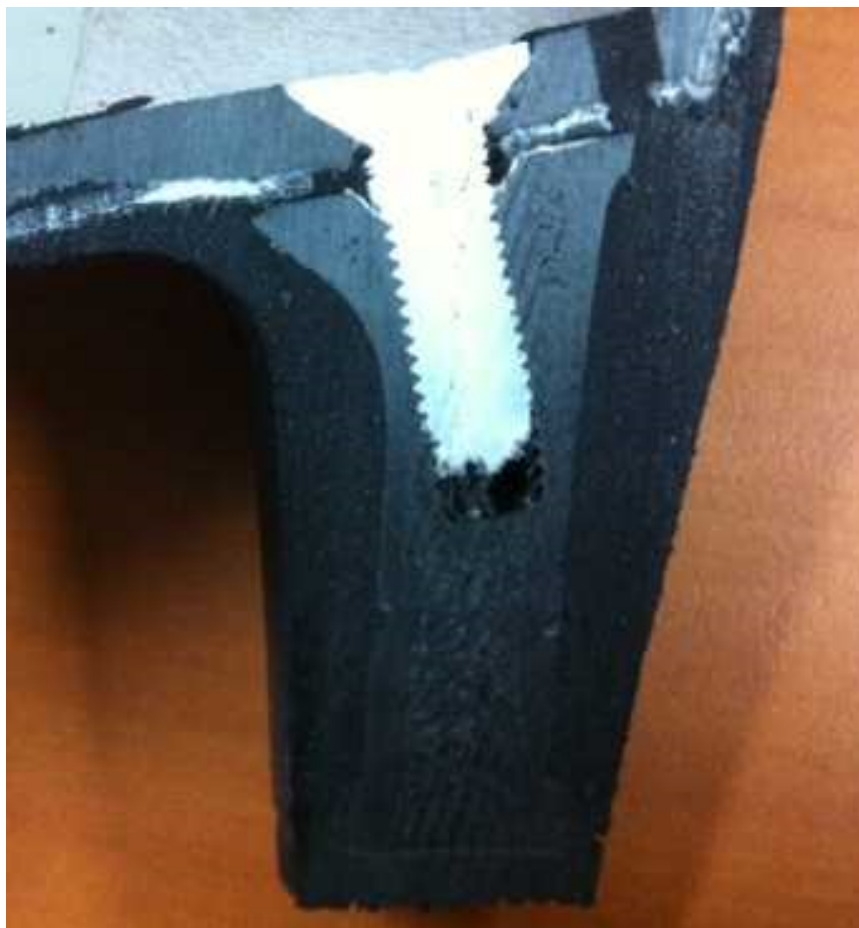
Figura 37 - Corte longitudinal do sapato acabado.
