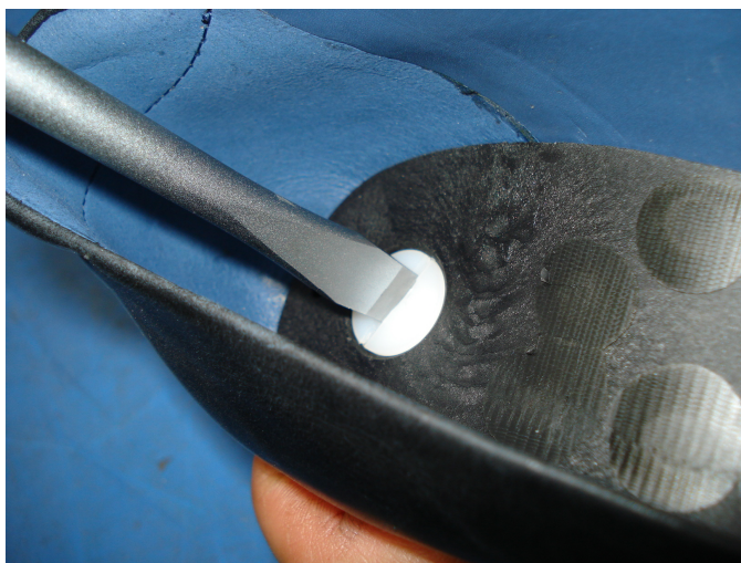
Figura 35 - Colocação do parafuso a unir o shank à estrutura do tacão.
