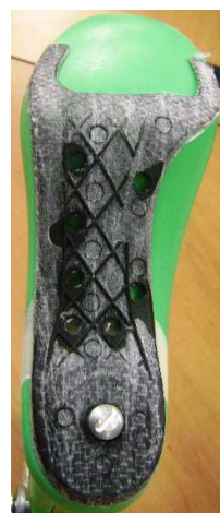
Figura 34 - Shank colocado na forma e colocação da estrutura do tacão no molde
