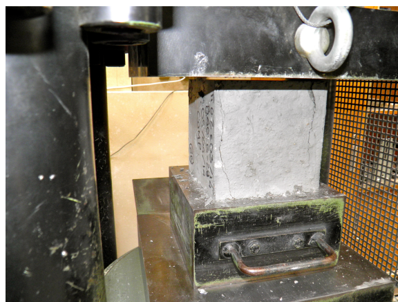
Fig. 4.14 – Ensaio de compressão
