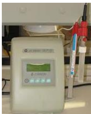
Figura 6.4 – Eléctrodo de vidro combinado conectado a um decimilivoltímetro (Crison®, modelo pH meter GLP 22) [159] .
