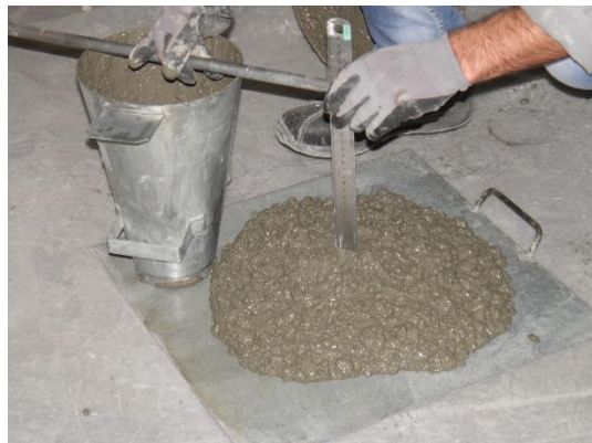
Fig. 2.7 – Ensaio de slump (abaixamento)
