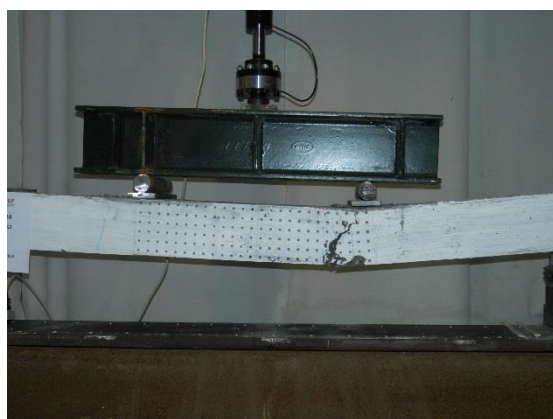
Fig. 4.17 – Fotos do modo de rotura das vigas 1D
