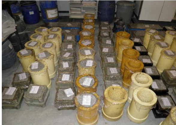
Fig. 3.4 - Provetes cobertos com filme e a identificação
