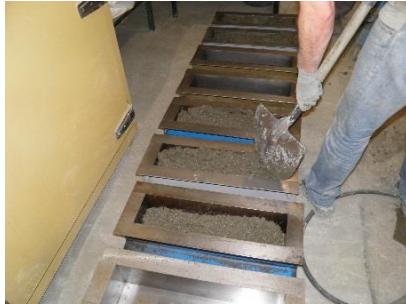
c) Moldes (prismas e cofragens das vigas)
