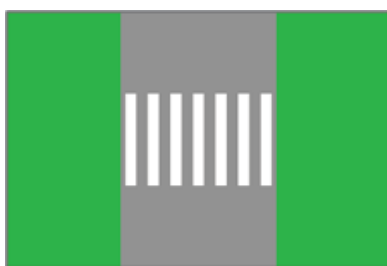
Figura 4.2 - Travessia pedonal com marcação M11 - zebra
