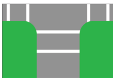
Figura 4.3 - Travessia pedonal com marcação M11a - guias
