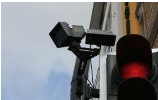
Figura 5.10 - Sensor de infravermelhos em Bristol, Reino Unido ( www.fhwa.dot.gov )
