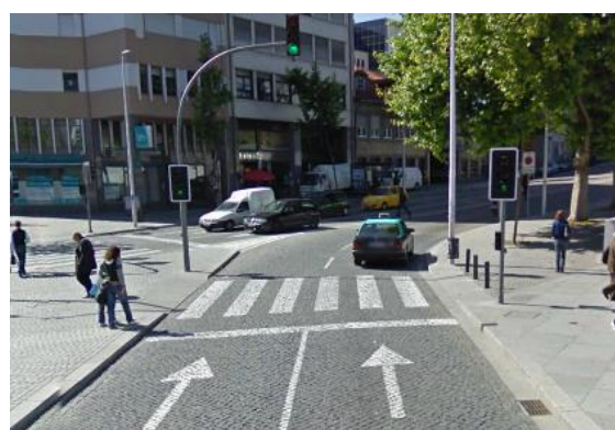
Figura 6.2 - Travessia do tipo 2 - Duas vias
