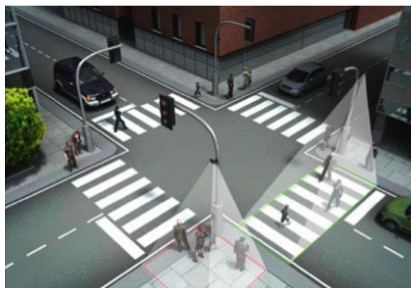
Figura 5.11 - Travessia com deteção através de sensores de infravermelhos (www.flir.com)
