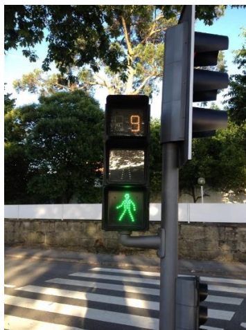
Figura 5.9 - Exemplo de dispositivo de contagem regressiva da Cidade do Porto
