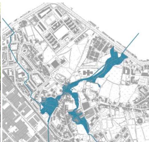
Figura 10 – Perímetro sujeito a cheias nos troços do Viso e da Quinta do Rio da ribeira da Granja, assinalado a azul, de acordo com o PDM do Porto, 2005 (cedido pela AdP).
