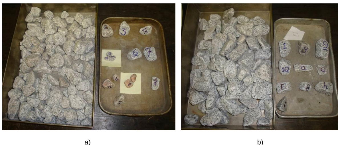
Figura 83 – Amostra e partículas selecionadas depois dos ensaios: a) Los Angeles ; b) Micro-Deval .
