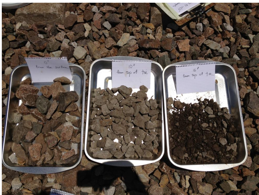
Figura 6 – Amostras de balastro recolhido à superfície, a cerca de 25,4 cm da superfície e a 40,6 cm da superfície (Moaveni et al. , 2014).
