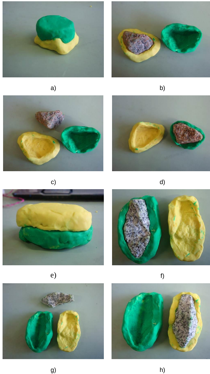
Figura 40 - Moldes de plasticina: a) encaixe de negativos da pedra I; b) negativos da pedra I – vista 1; c) pedra I e pormenor da impressão da forma nos moldes; d) Negativos da pedra I – vista 2; e) encaixe de negativos da pedra II; f) negativos da pedra II – vista 1; g) pedra II e pormenor da impressão da forma nos moldes; h) negativos da pedra II – vista 2.
