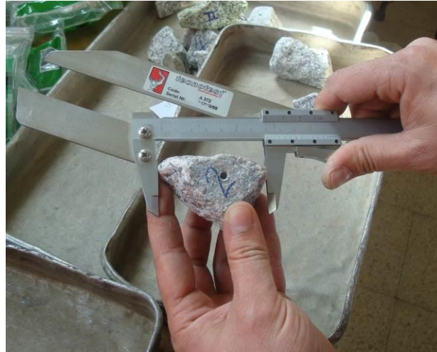
Figura 74 - Determinação da forma da pedra 2 com paquímetro.
