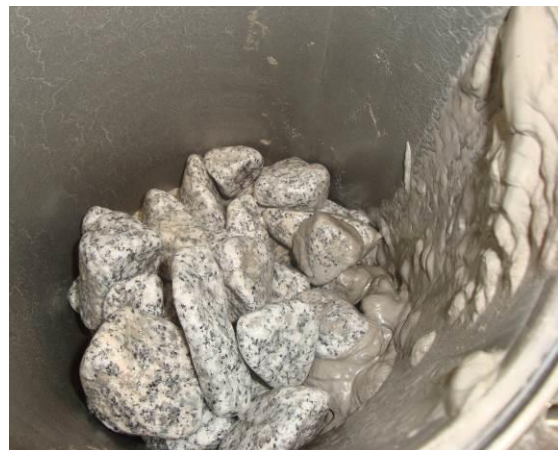
Figura 80 - Amostra de balastro e esferas de aço dentro do tambor rotativo da Máquina de Los Angeles no início do ensaio.
