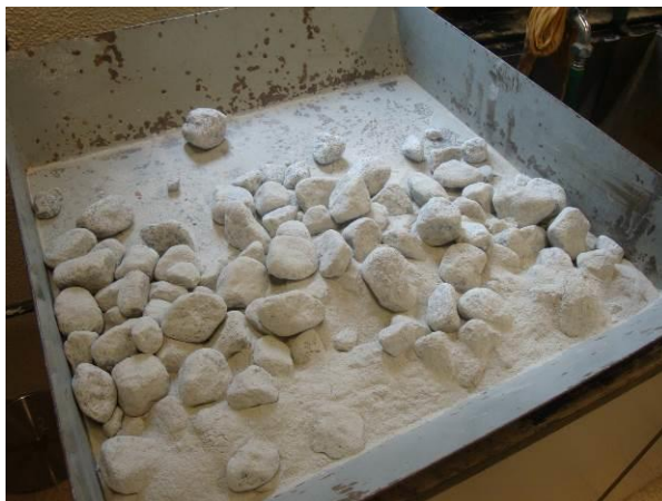
Figura 80 - Amostra de balastro e esferas de aço dentro do tambor rotativo da Máquina de Los Angeles no início do ensaio.
