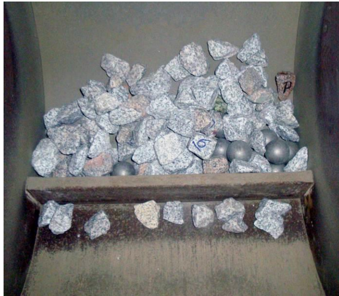
Figura 80 - Amostra de balastro e esferas de aço dentro do tambor rotativo da Máquina de Los Angeles no início do ensaio.
