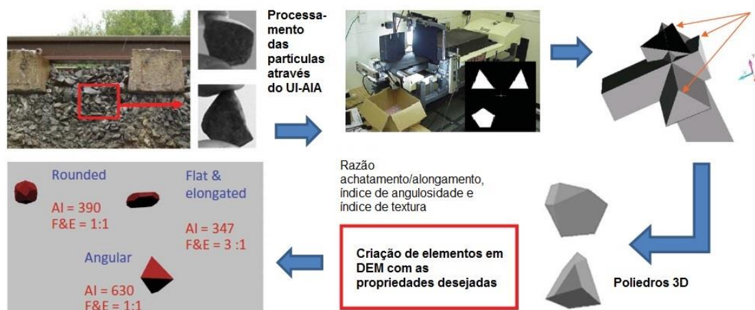
Figura 37 – Processo de modelação de balastro em DEM (Tutumluer et al. , 2013, adaptado).
