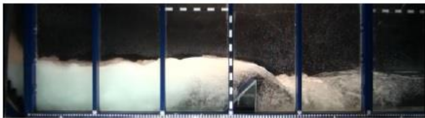
Figura 4.30 - Escoamento tipo Weir flow (Conterato, 2014).
