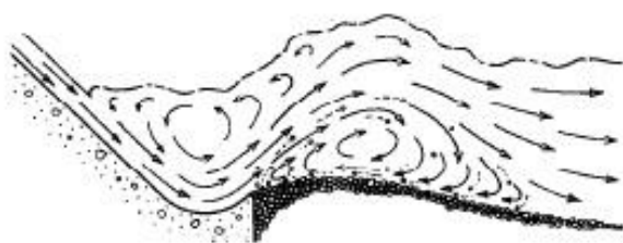
Figura 2.11 - Escoamento com roller bucket não dentado (Peterka, 1957).
