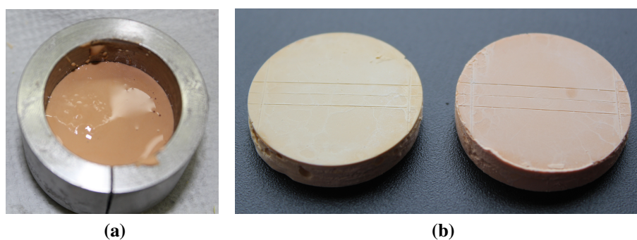
Figura 4. Vazagem das amostras a gesso: (a) Colocação do gesso dentro do cilindro ilustrado na Figura 2; (b) Modelos de gesso tipo III (esquerda) e tipo IV (direita).
