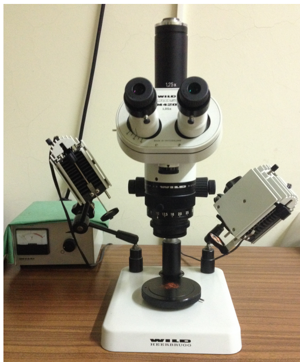
Figura 5. Lupa (WILD MAK ROSKOP M420 - HEERBURGG) com ampliação de 10x com luz em baixo ângulo.
