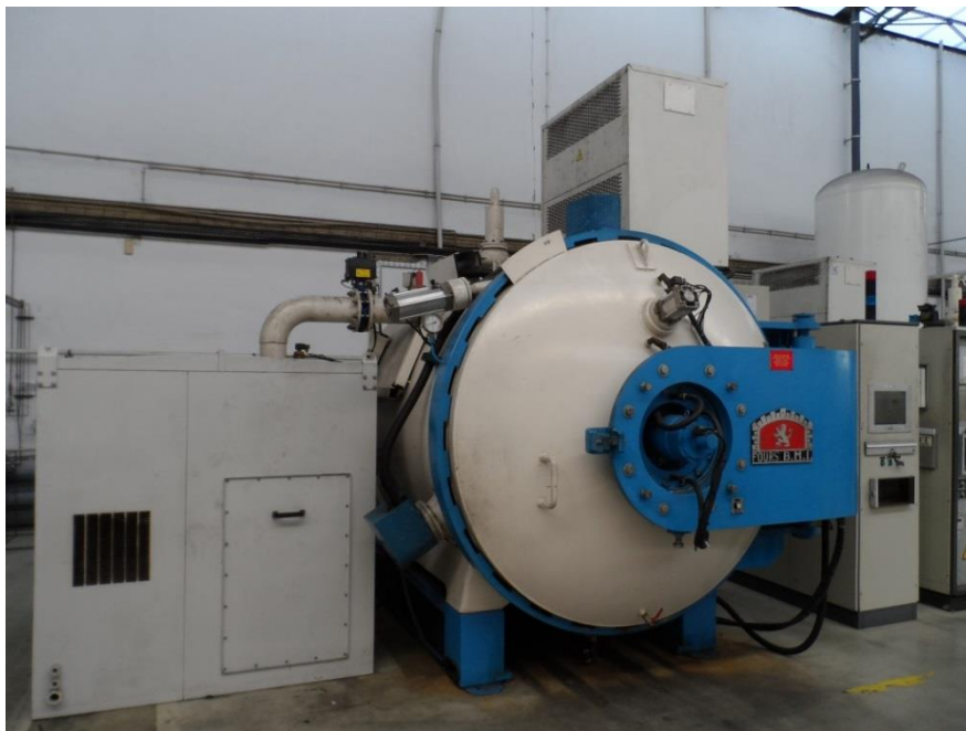
Figura 1-3 – Forno da empresa F. Ramada utilizado para efetuar tratamentos térmicos.
