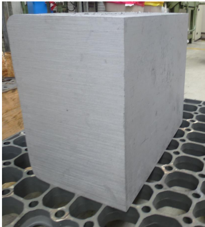
Figura 4-14 – Bloco após o tratamento térmico de têmpera.
