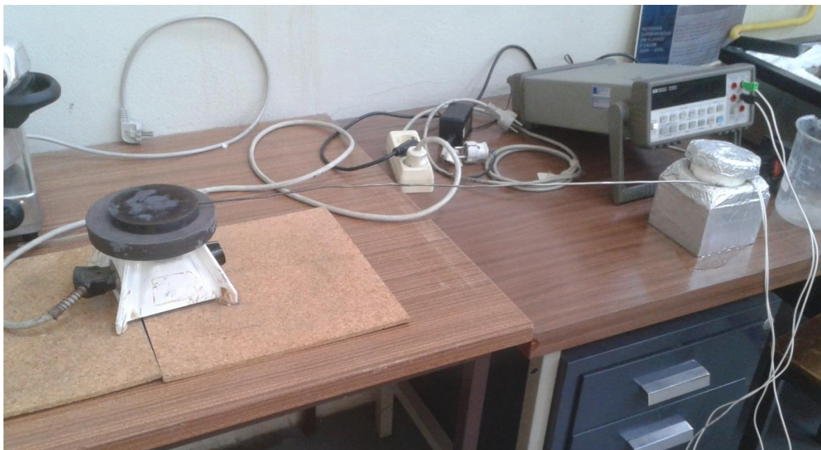
Figura B-1 – Instalação experimental utilizada no estudo experimental da variação da emissividade com a temperatura.
