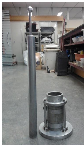
Fig.6.15 - Molde e pilão utilizados no ensaio de compactação tipo Proctor modificado
