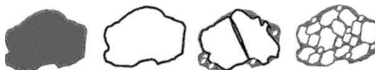
Fig.3.1 – Possíveis composições de um grumo resultante da fresagem a frio [21]
