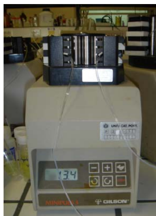
Figura 9 - Bomba peristáltica Gilson Minipuls 3 utilizada na metodologia SIA.
