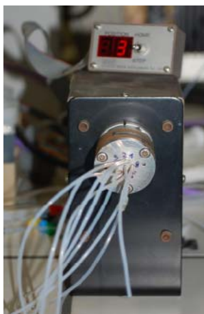
Figura 10 - Válvula selectora de fluidos de oito portas utilizada no sistema SIA.
