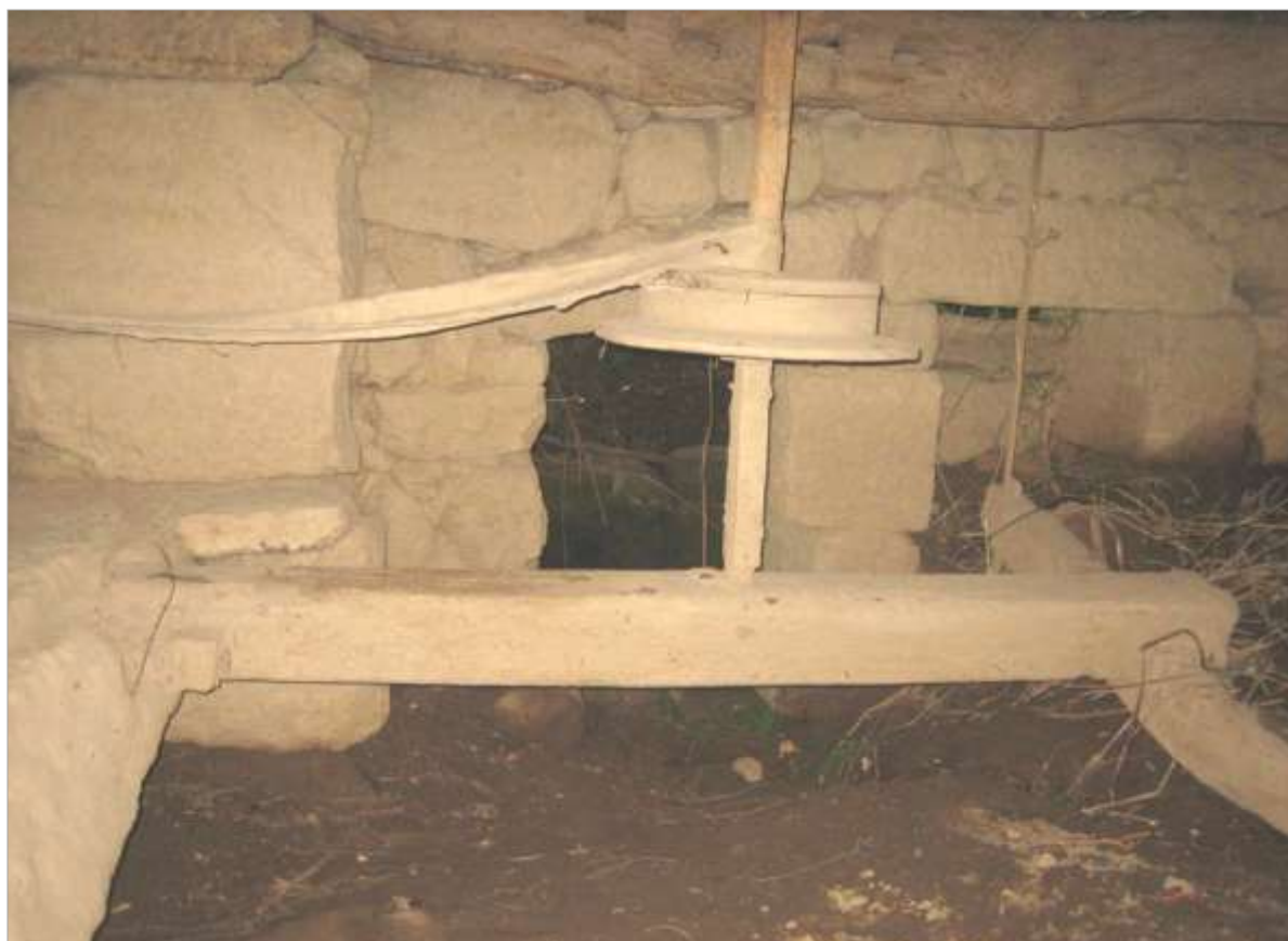
Fig. 12. Sistema de tambor e correia que aciona um casal de mós
