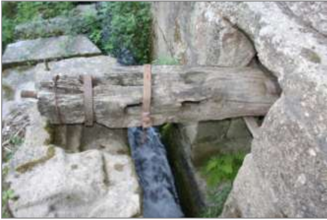
Fig. 9. Eixo e aguilhão em ferro
