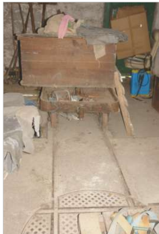
Fig. 39. Carris metálicos para movimentação do carrinho
