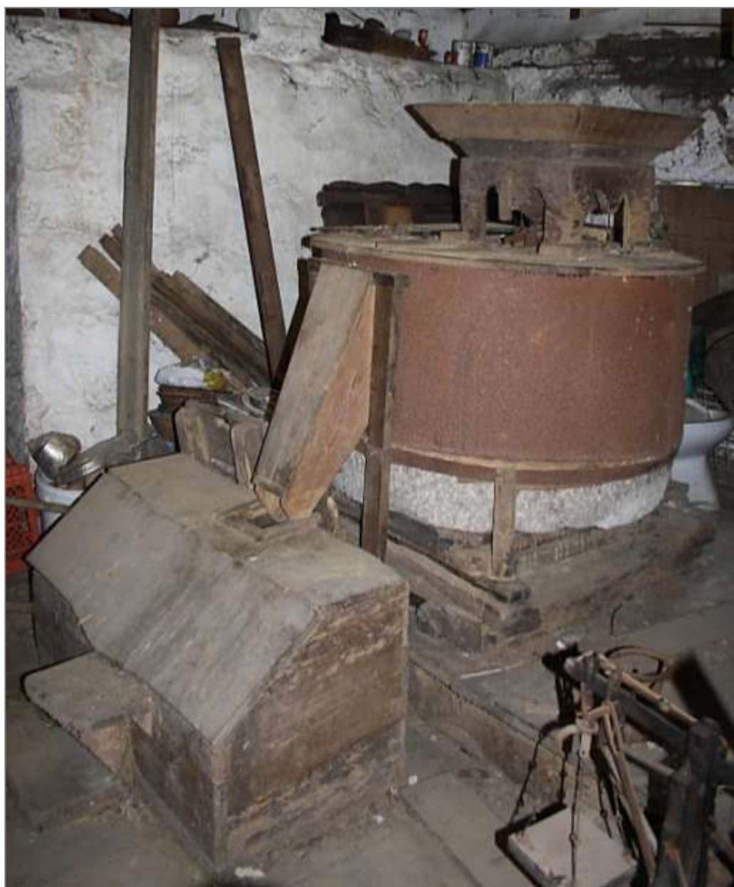
Fig.18. Moenda da roda vertical a montante (des. 1)
