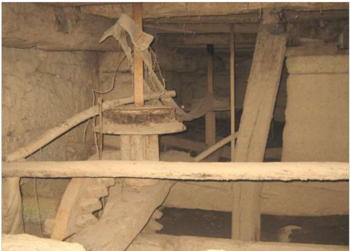
Fig.11. Sistema de transmissão por correias de ligação dos dois tambores
