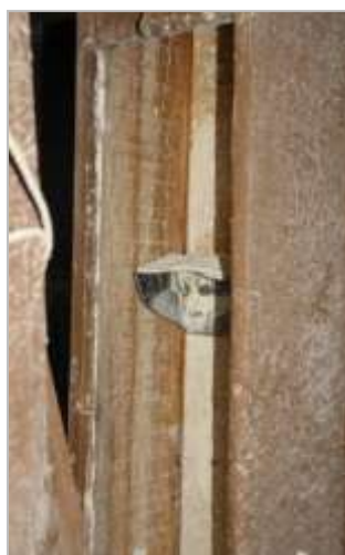
Fig. 26. Correias elevatórias com colheres, no interior das condutas
