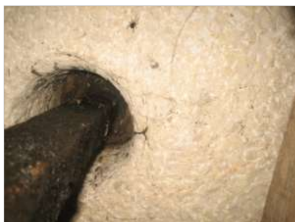
Fig.13. Veio e bucha de madeira no olho da mó
