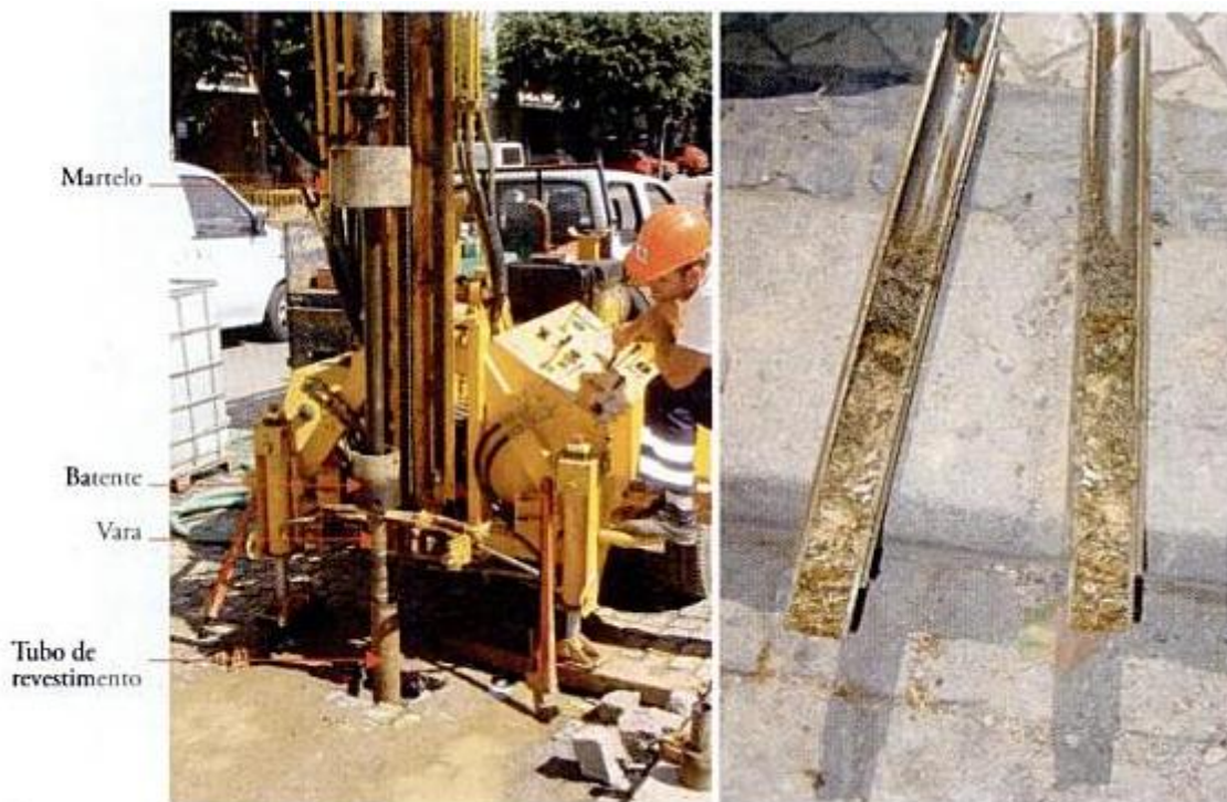
Fig. 4.2 - À esquerda: vista do ensaio com o martelo pronto a cair; À direita: amostrador aberto após o ensaio (Matos Fernandes, 2011b)
