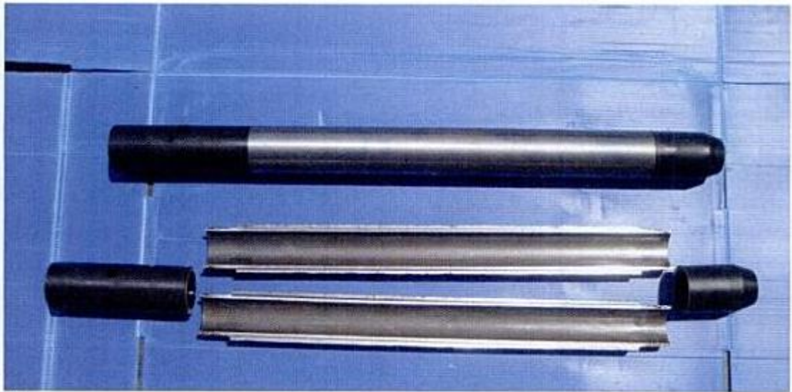
Fig. 4.1 - Ensaio SPT: Amostrador Normalizado de Terzaghi (Matos Fernandes, 2011b)
