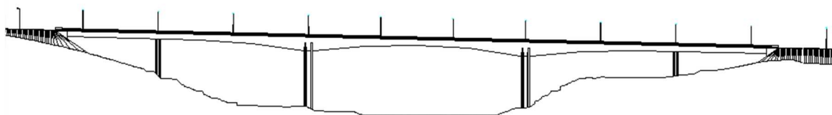
Fig. 2 – Vista geral de uma ponte de secção variável
