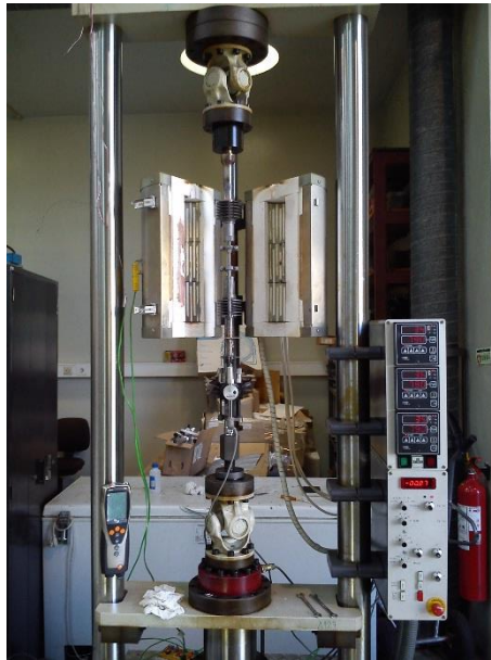
Figura 17- Máquina de fluência com todo o equipamento para realização do ensaio
