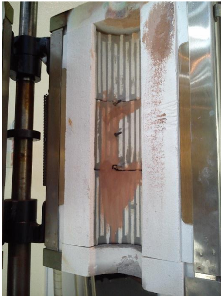
Figura 13- Forno do equipamento
