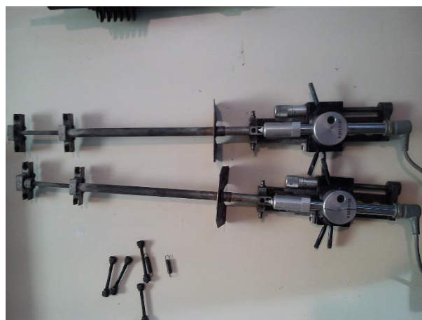
Figura 12- Extensômetros mecânicos do tipo LVDT
