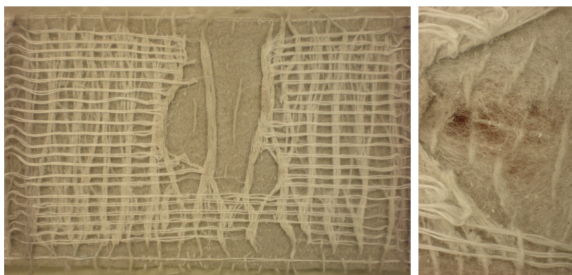
Fig. 5.5: a) Provete após danificação de DDI+ABR, na DF, lado CF, b) buraco no geotêxtil
