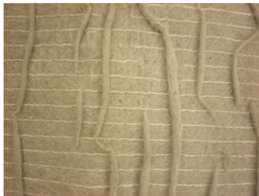
Fig. 5.1: Provete com aglomerados de material
