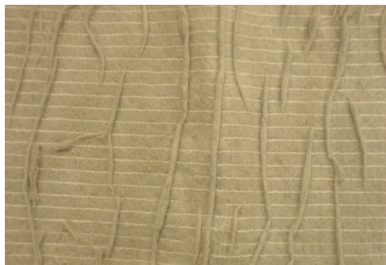
Fig. 5.8: Provete após ensaio de DDI + ABR, na DF, lado SF
