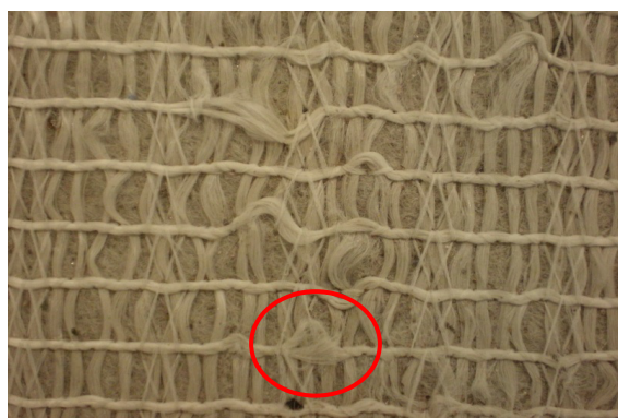
Fig. 5.3: Proвете com filamento cortado após ensaio de DDI, na DF, lado CF
