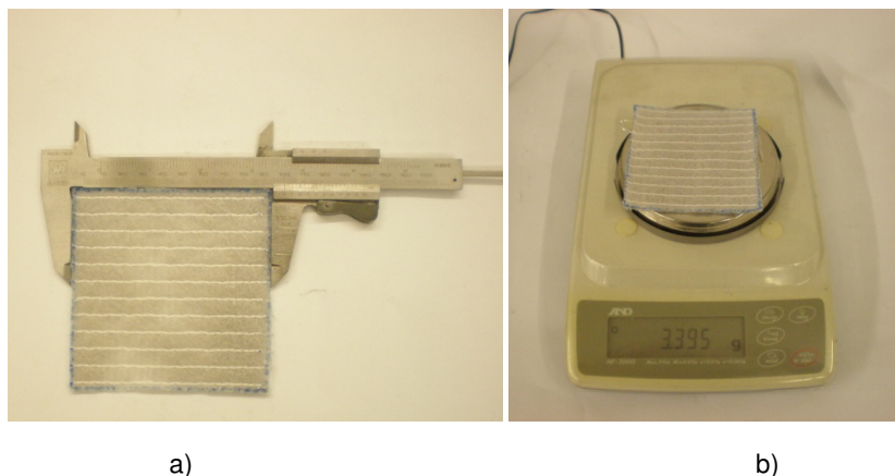
Fig. 4.2: Ensaio de massa por unidade de área. a) medição de um provete com craveira, b) pesagem de um provete com balança analítica
