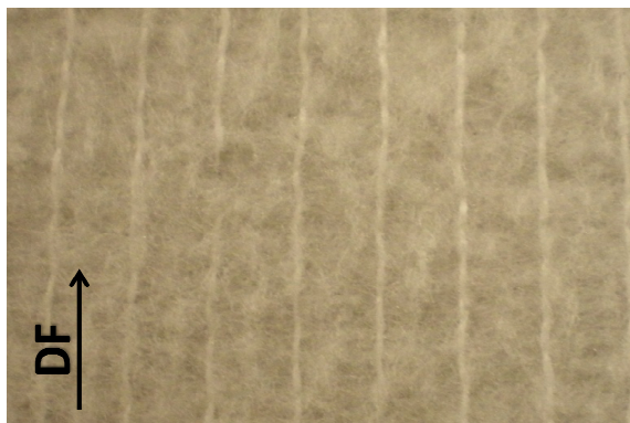
Fig. 5.12: Provete após ensaio de abrasão, na DPF, no lado SF
