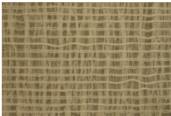
Fig. 5.4: Provete após ensaio de ABR, na DF, lado CF
