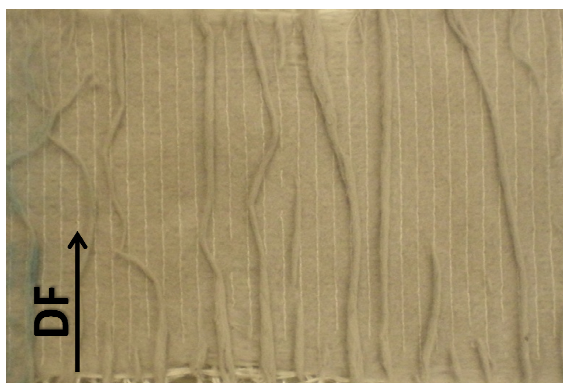
Fig. 5.13: Provete após ensaio de DDI + ABR, na DPF, no lado SF
