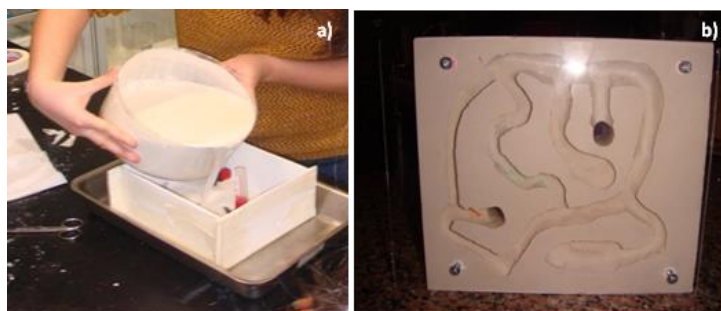
Fig. A9 – a) Fotografia do procedimento de verter o gesso no molde de formicário; b) Fotografia do modelo de formicário final, já com o plástico transparente de proteção.
