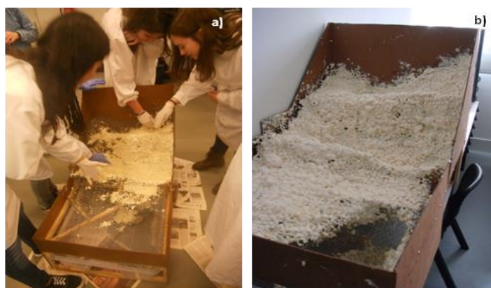
Fig. A4 - a) Fotografia da aplicação da espuma de poliuretano de forma a impermeabilizar o modelo e a conferir maior relevo; b) Fotografia do modelo final de bacia hidrográfica com espuma de poliuretano.
