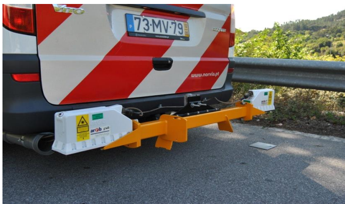
Fig.2.7. – Equipamento do tipo Perfilómetro Laser (Hawkeye 1000). [Extraída do ensaio realizado em 23/04/2014]
