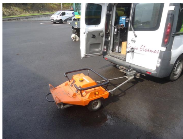
Fig. 2.12. – Grip Tester – Equipamento para medição do coeficiente de atrito de um pavimento. [Extraída do ensaio realizado em 23/04/2014]
