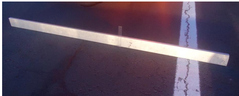
Fig. 2.9. – Procedimento da medição da regularidade transversal – “Régua de três metros”. [Extraída do ensaio realizado em 23/04/2014]
