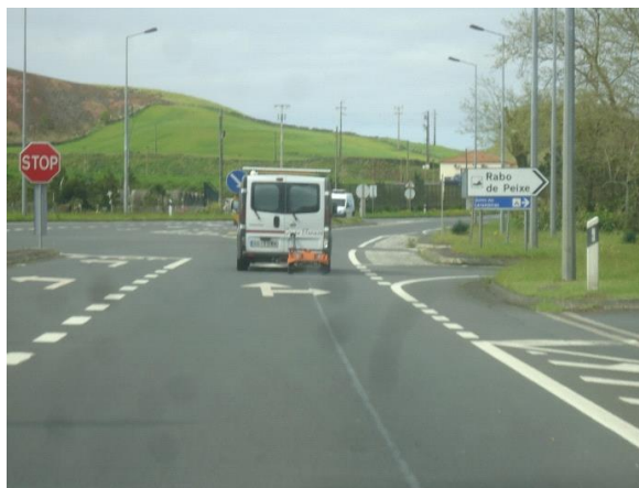
Fig. 2.13. – Representação do procedimento do ensaio, ilustrando-se a película de água projectada durante o ensaio. [Extraída do ensaio realizado em 23/04/2014]
