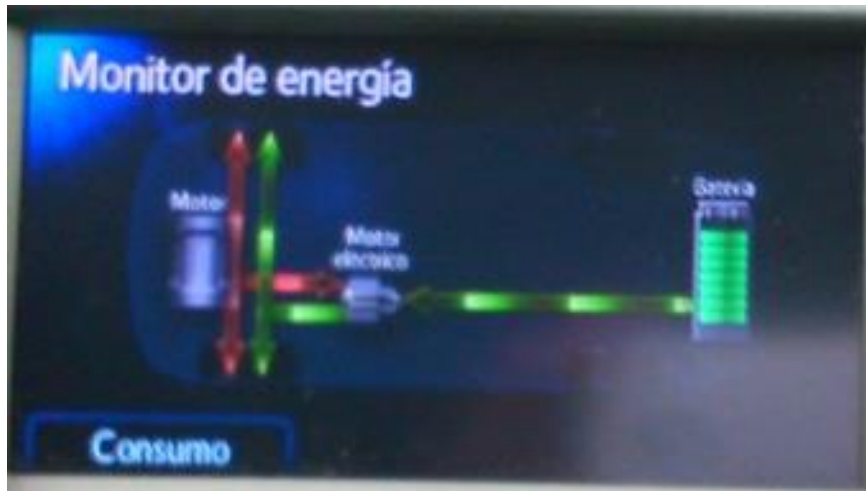
Figura 30 - Ecrã de monitorização com o veículo em aceleração com motor elétrico e combustão em funcionamento simultâneo
