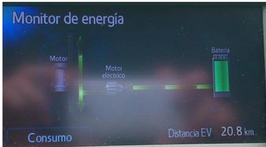
Figura 28 - Ecrã de monitorização com o veículo em movimento no modo elétrico
