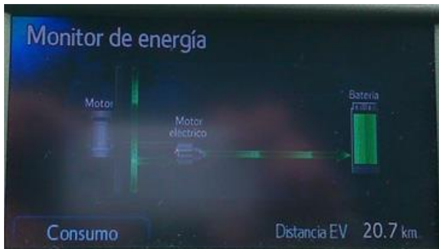
Figura 29 - Ecrã de monitorização com o veículo em desaceleração
