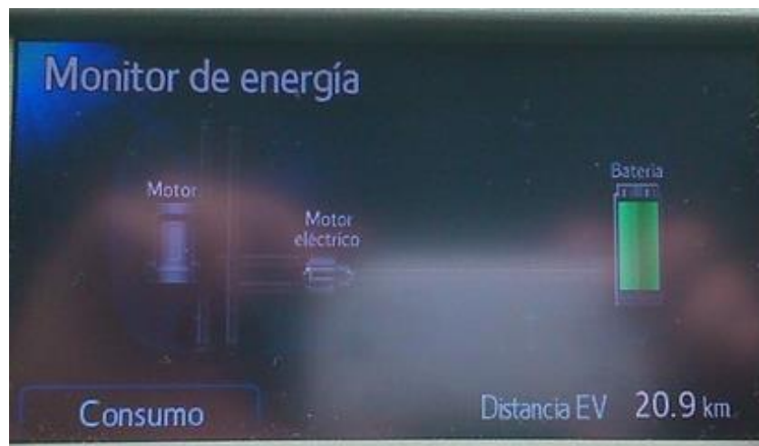
Figura 27 - Ecrã de monitorização com o veículo parado
