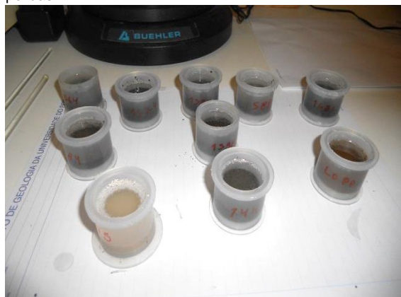
Figs. 14a) Resina e endurecedor; 14b) Amostras já preparadas em fase secagem da resina.
