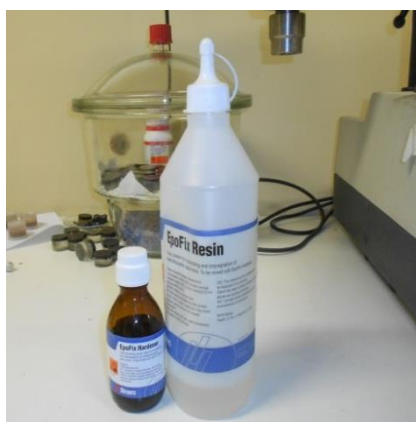
Figs. 14a) Resina e endurecedor; 14b) Amostras já preparadas em fase secagem da resina.
