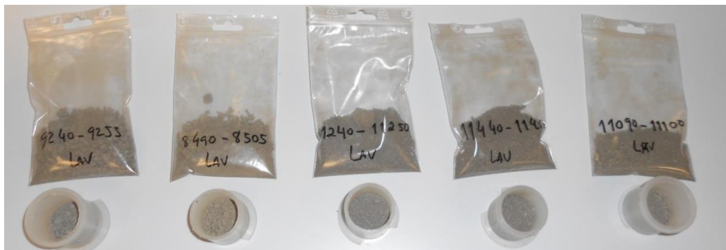
Fig.13. Colocação das amostras em moldes de plástico devidamente identificados para preparação das superfícies polidas.
