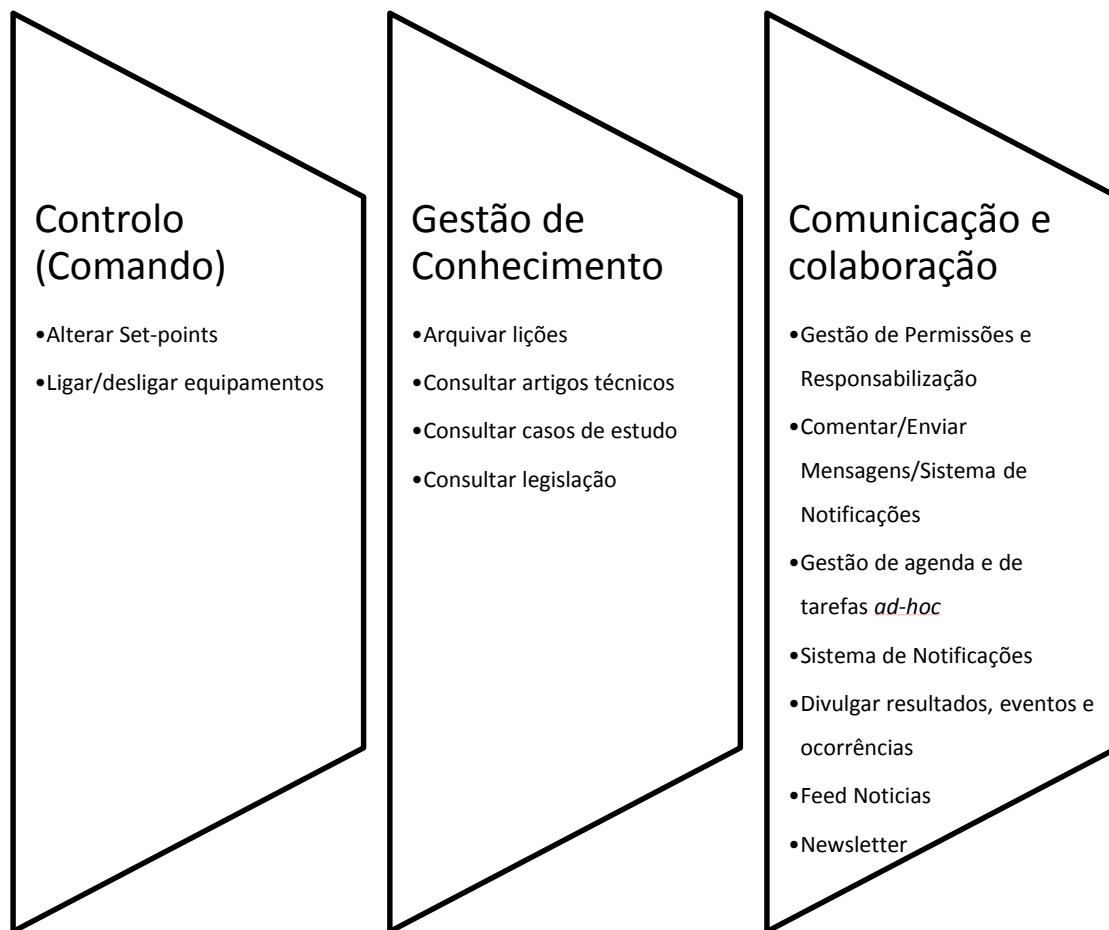
Figura 4.3 - Módulos de sistema de gestão de energia da plataforma
