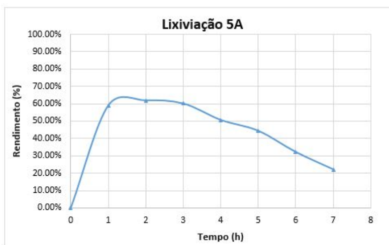
Figura 5.7: Cinética da reação no 5º ensaio de lixiviação do minério A, para 6 horas.
