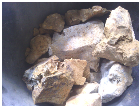
Figura 3.6: Amostra primária para fragmentação em britador de maxilas.
