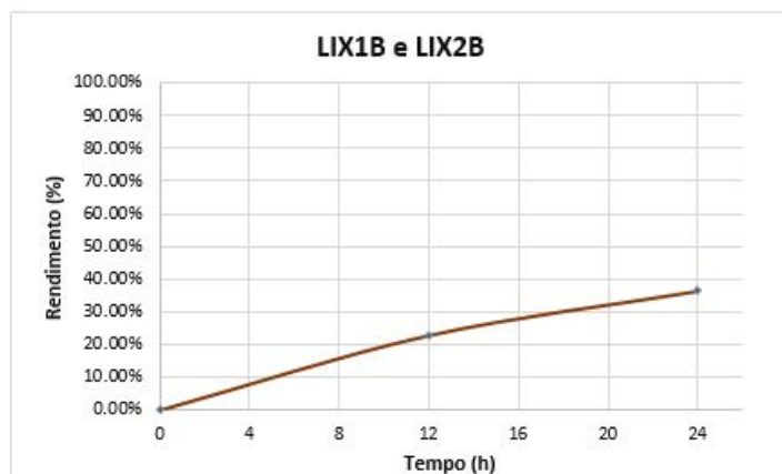
Figura 5.5: Lixiviação da amostra B, com KCN 0,2% (w/w), com 200 g de minério, % S = 33 %, durante 12 horas (LIX2B) e para 24 horas (LIX1B).
