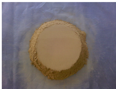
Figura 3.4: Quartejamento do material através de pilha cónica.
