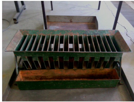
Figura 3.5: Separador Jones usado nos quartejamentos.
