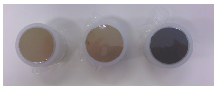
Figura 3.17: Amostras do material de granulometria inferior a 1,7 mm, desenlameado na jiga e submetido à mesa Wilfley. Da esquerda para a direita: rejeitado, mistos e concentrado.
