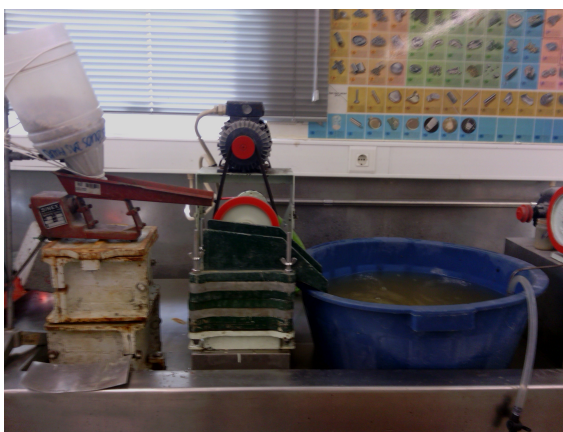
Figura 3.10: Esquema da alimentação e da jiga em funcionamento.
