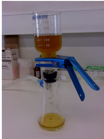
Figura 4.5: Filtração a vácuo da fração líquida da lixiviação, com Malononitrilo 0,05%.
