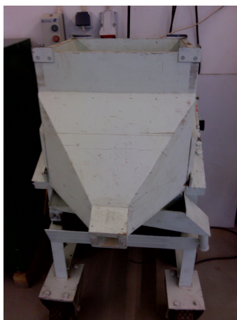
Figura 3.9: Crivo vibratório no qual se usou uma rede de 1,7 mm.
