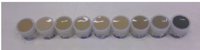
Figura 3.15: Amostras dos produtos finais da jiga. Da esquerda para a direita: sólidos decantados (fração fina e fração grosseira), rejeitados, mistos, hutch e concentrado.
