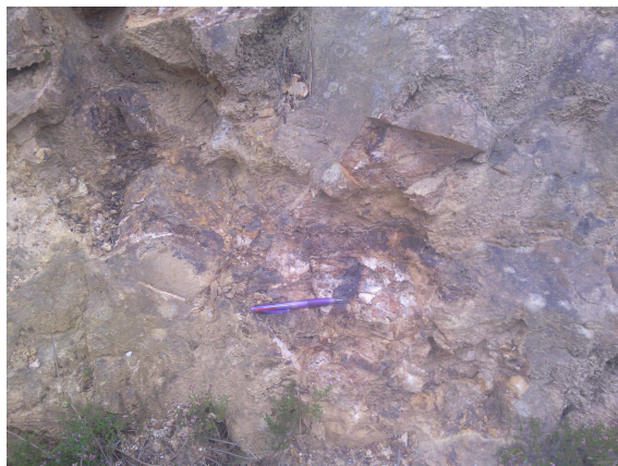
Figura 3.3: Pormenor do filão mineralizado, no qual foram recolhidas amostras para o presente trabalho.
