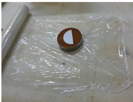
Fig. 3.17 - Ensaio Método do Papel Filtro. a) Pesagem da amostra; b) Saturação da amostra; c) Colocação papel filtro.
