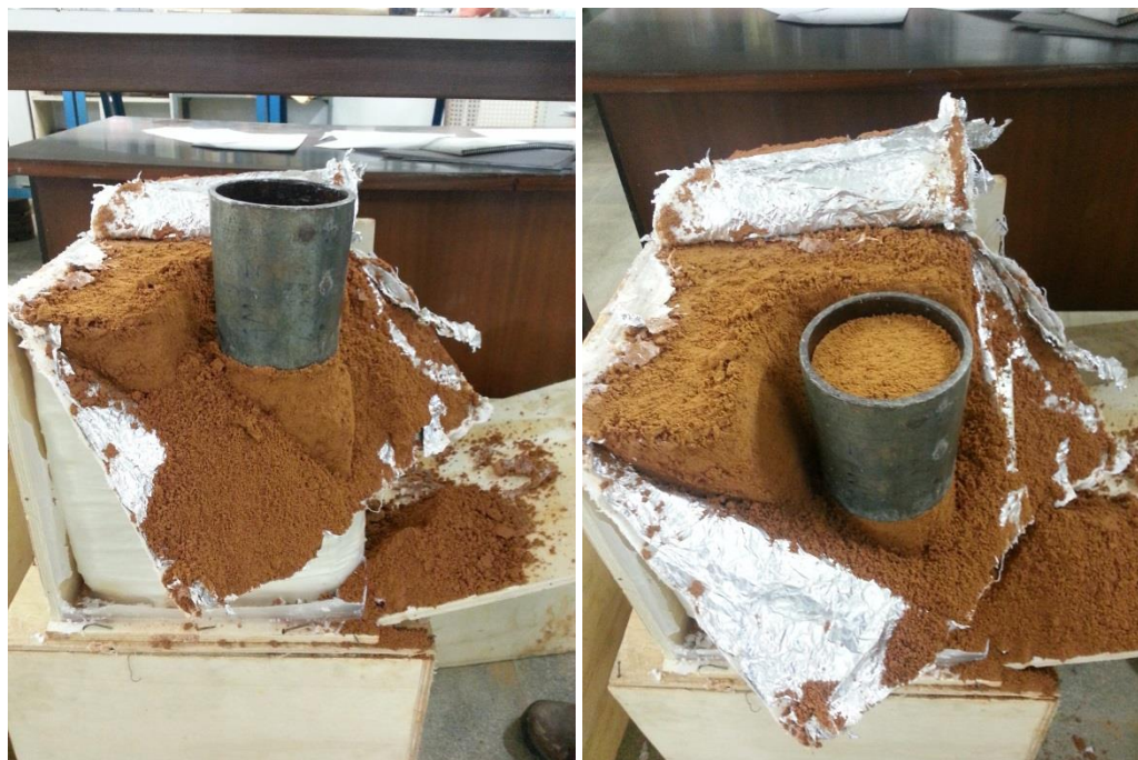
Fig. 3.21 - Moldagem de amostra para Ensaio de Permeabilidade TRI-FLEX II.
