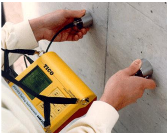
Figura 3.9 – Medição com uso do TICO (Catologue, P., 2007)
