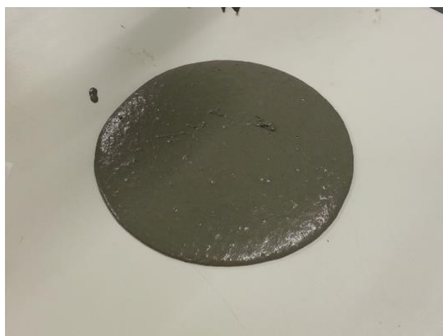
Figura 4.24 – Ensaio de Espalhamento de Argamassas
