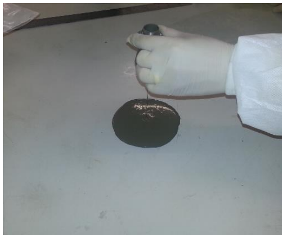
Figura 4.15 – Ensaio de Espalhamento com uso de Mini-cone de Kantro
