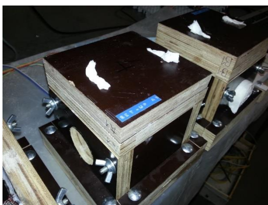
Figura 4.8 - Molde HCA (série S3) com isolamento de papel na tampa
