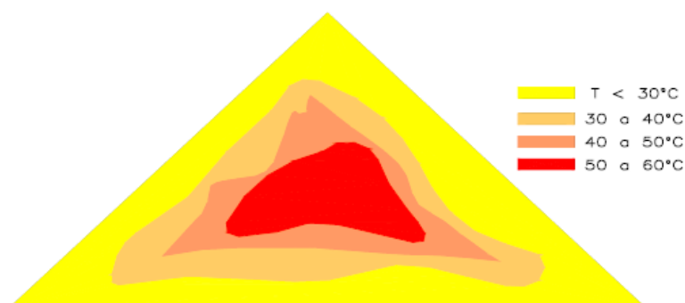
Figura 13 – Perfil de distribuição de temperaturas típico de uma pilha de compostagem [37] .
