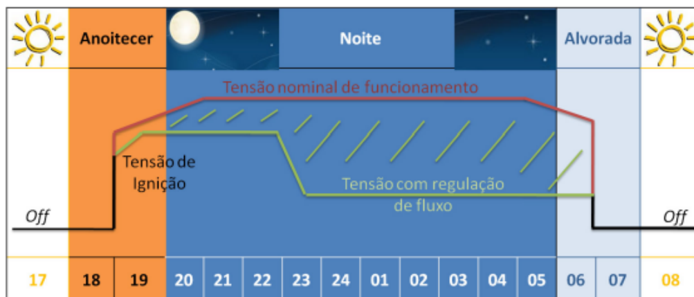
Figura 6.17: Exemplo de funcionamento de um Regulador de Fluxo Luminoso ao longo do período nocturno [3].
