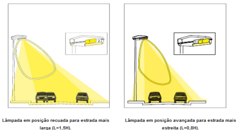
Figura 4.39: Possibilidade de ajustamento da posição da fonte luminosa numa luminária [33].
