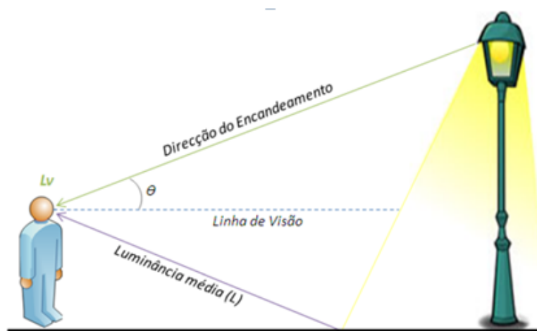
Figura 3.16: Esquemática dos parâmetros para o cálculo do TI [24].
