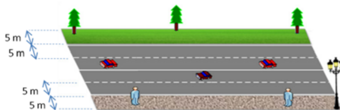
Figura 3.18: Largura máxima das faixas para cálculo do SR [24].
