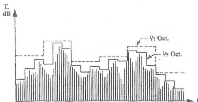
Figura 2.3 – As linhas a tracejado representam o nível de pressão sonora obtido para bandas de frequência de 1/1 oitava. As linhas a cheio representam o mesmo parâmetro para as bandas de largura 1/3 de oitava. Uma vez que as bandas de 1/1 oitava implicam a adição logarítmica de um maior número de sinais sonoros, a sua intensidade é maior do que a obtida para as de 1/3 de oitava. [2]
