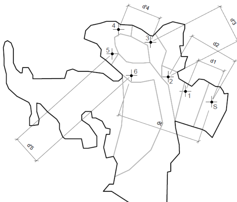
Figura 5.3 – Localização dos pontos de medição no espaço estudado nas grutas da Moeda (pontos 1 a 6, e localização da fonte sonora – ponto S).
