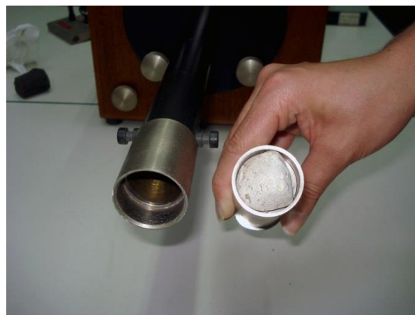
Figuras 6.2 e 6.3 – À esquerda: tubo de ondas estacionárias para baixas e médias frequências com diâmetro de 10 cm e respetiva base para colocação da amostra; à direita: tubo de ondas estacionárias para altas frequências com diâmetro de 3 cm e respetiva base para colocação da amostra. [fotografias da autora]
