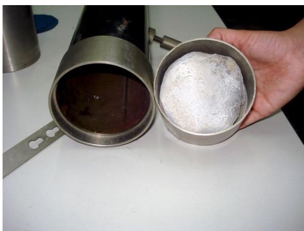
Figuras 6.2 e 6.3 – À esquerda: tubo de ondas estacionárias para baixas e médias frequências com diâmetro de 10 cm e respetiva base para colocação da amostra; à direita: tubo de ondas estacionárias para altas frequências com diâmetro de 3 cm e respetiva base para colocação da amostra. [fotografias da autora]
