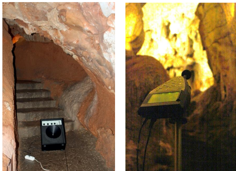
Figuras 5.1 e 5.2 – À esquerda: Fonte sonora para medição do T Brüel & Kjær – modelo 4224; à direita: sonómetro Brüel & Kjær – modelo 2260. [fotografias da autora]
