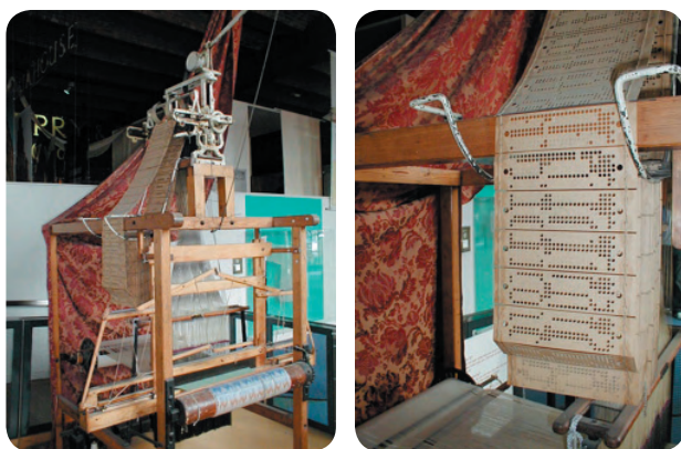
Figura 4 Tear de Jacquard, a primeira máquina a utilizar programação por cartões perfurados.
