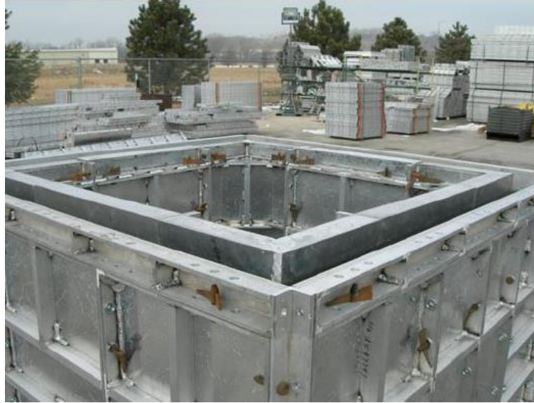
Fig. 3. 7 Molde metálico para pré-fabrico do Box Culvert (Hanson et al, 2011)
