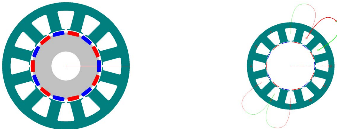
Figura 3.24 - Constituição da configuração (12 Ranhuras/14 Pólos)
