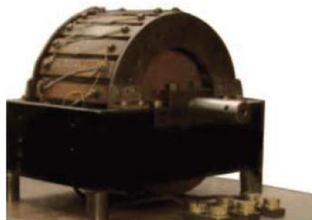
Figura 1.1 - Motor trifásico patenteado em 1889
