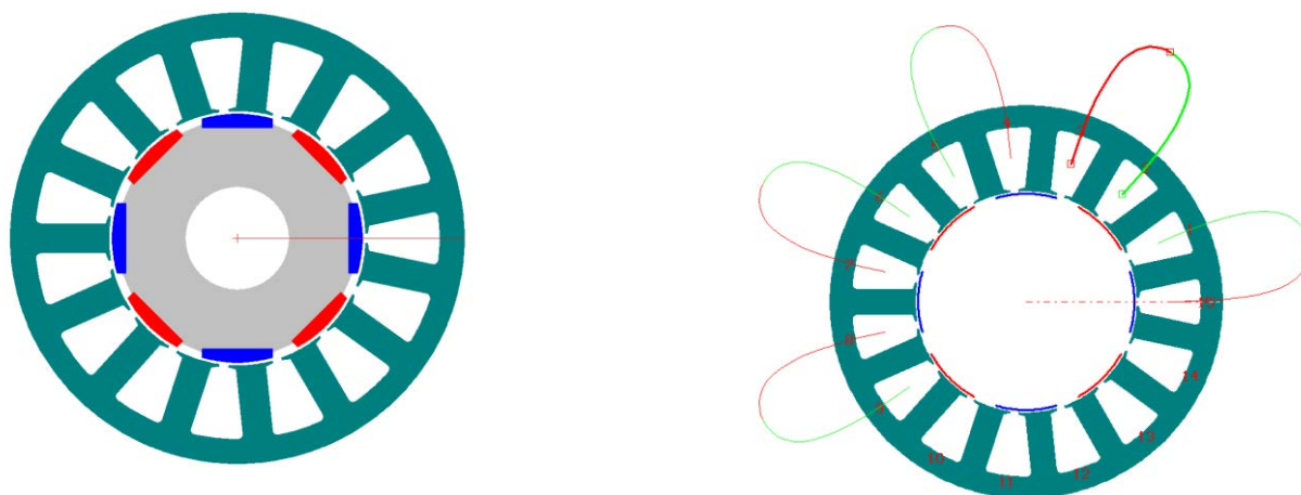
Figura 3.16 - Constituição da configuração (15 Ranhuras/8 Pólos)
