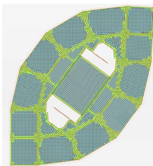
Fig. 5.29. - Identificação dos painéis da laje
