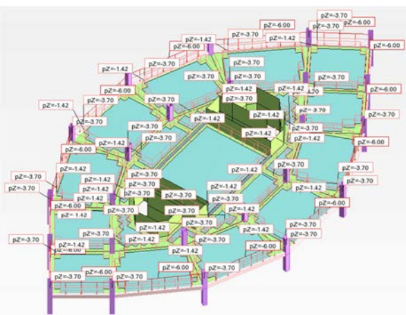
Fig. 4.4. - Ação do RCP – Laje Nervurada
