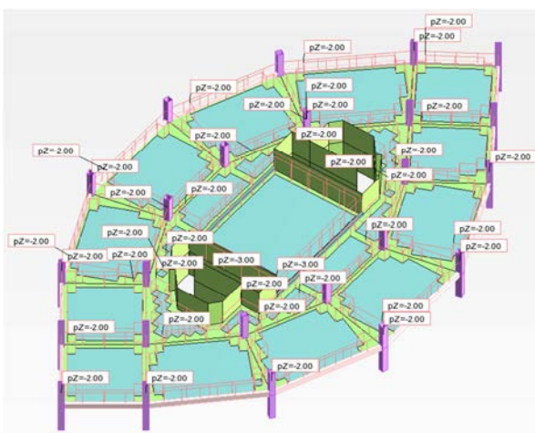
Fig. 4.6. - Ação da Sobrecarga – Laje Nervurada
