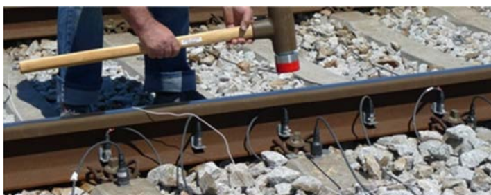
Figura 6.14 - Disposição dos acelerómetros no carril e nas travessas para a realização do ensaio de receptância
