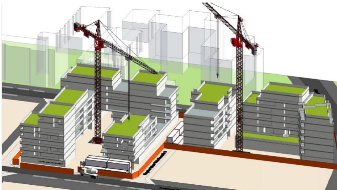
Fig. 4.5. - Análise de um plano de instalação de estaleiro com recurso a software BIM (REVIT)
