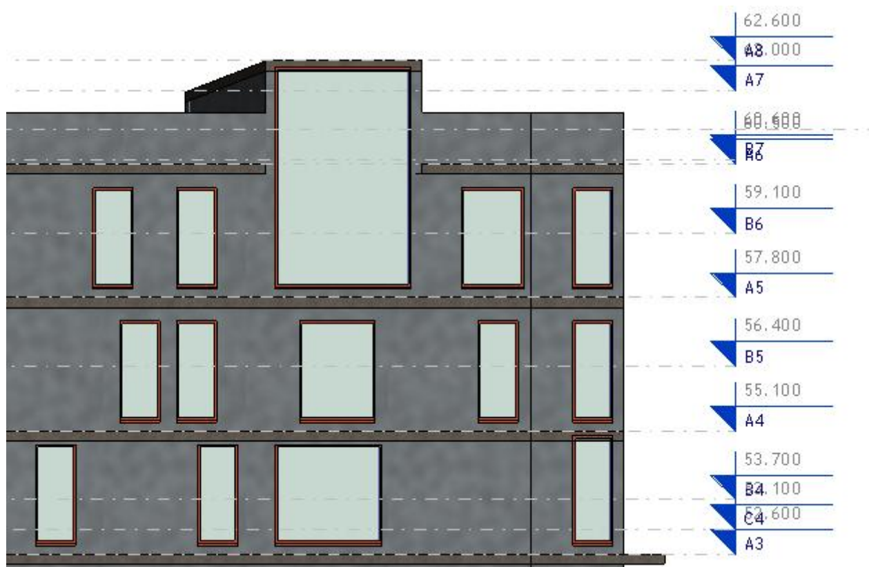
Fig. 5.10. - Identificação dos níveis e respetiva cotagem sobre o plano de fachada
