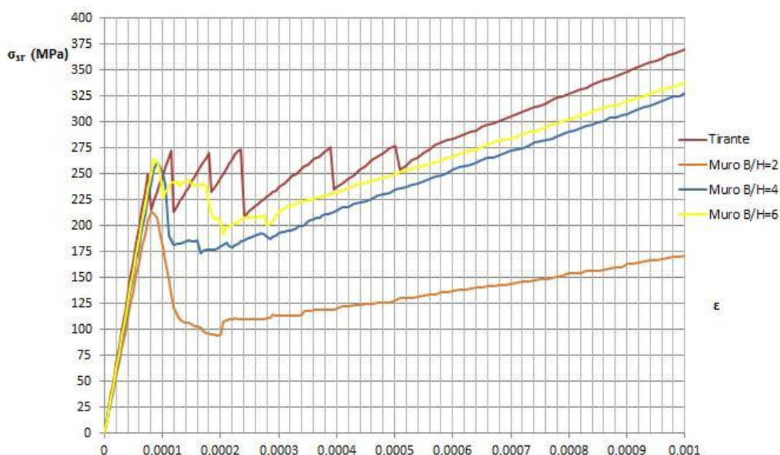
Figura 4.26 - Comparação das tensões na armadura para o elemento nº4 nos diferentes muros – Relação tensão-extensão
