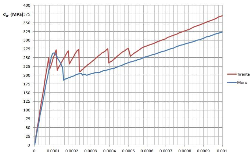
Figura 4.20 – Comparação entre um tirante e o elemento nº1 de um muro com relação B/H = 2 – Relação tensão-extensão
