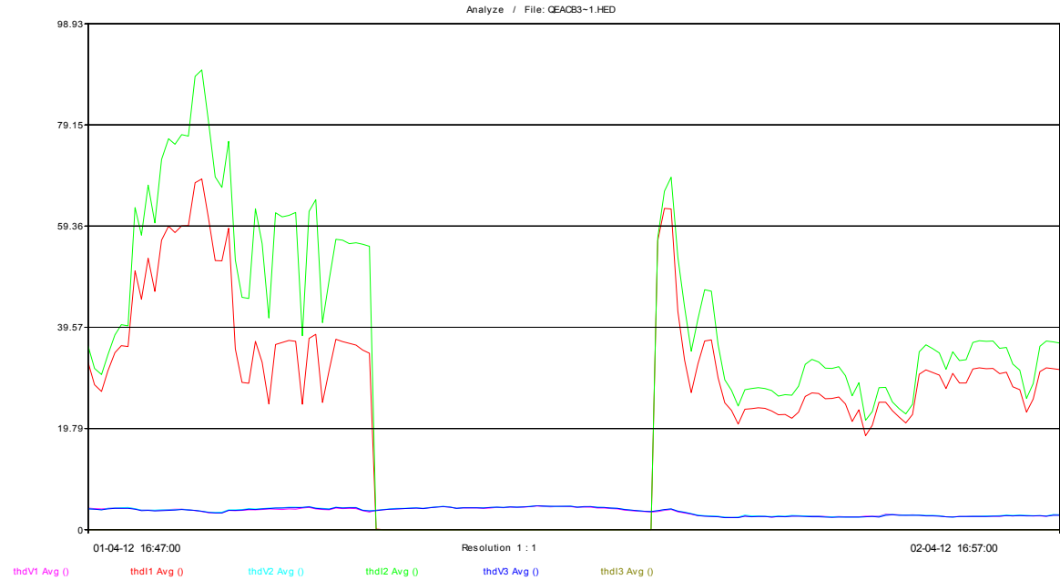
Figura 5.7 – Taxa de distorção harmônica medida no QEAC B3.1
