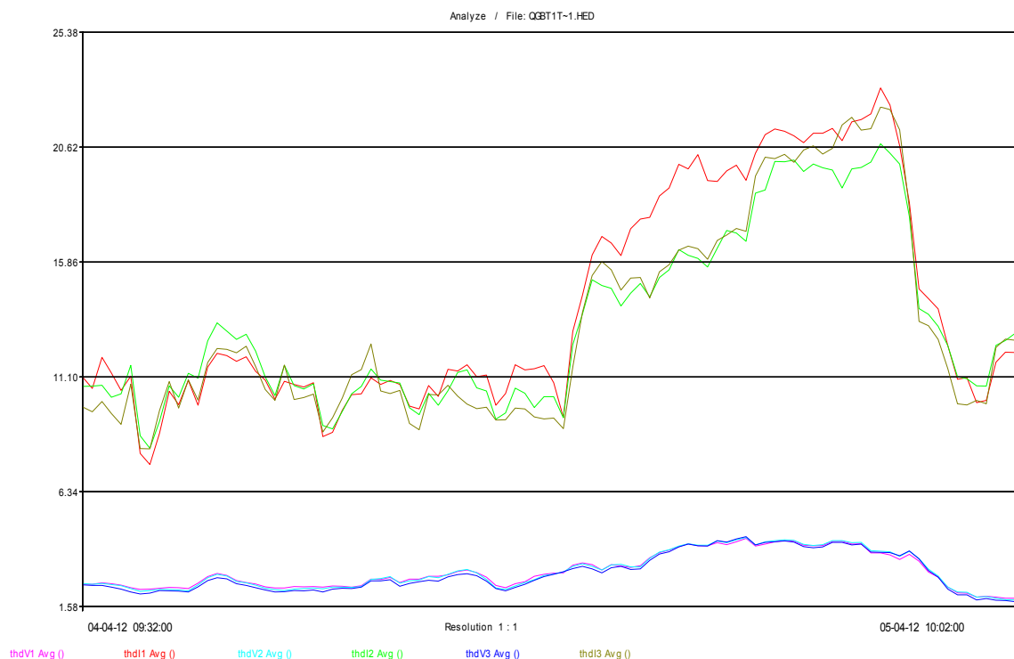
Figura 5.3 – Taxa de distorção harmônica medida na instalação (QGBT)
