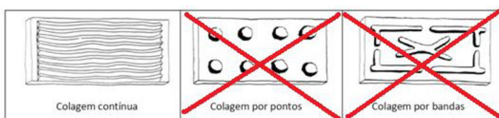
Figura 3.16 – Distribuição do produto de colagem sobre o ICB.
