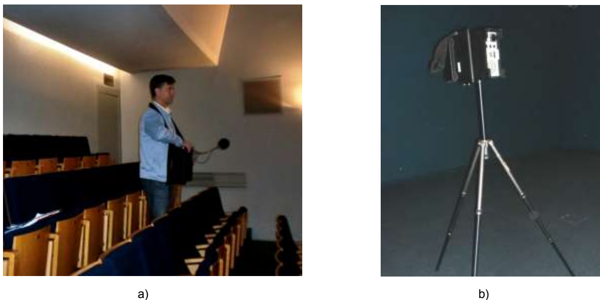
Fig. 4.14 – Medição do parâmetro RASTI: a) recetor, b) emissor [foto da autora]
