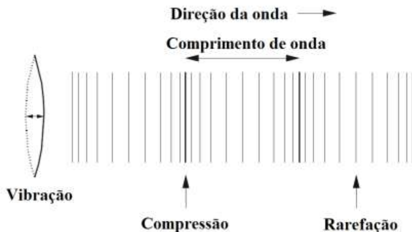
Fig. 2.2 - Propagação de ondas: alternância de áreas de compressão e rarefação numa onda sonora (Adaptado de [5])
