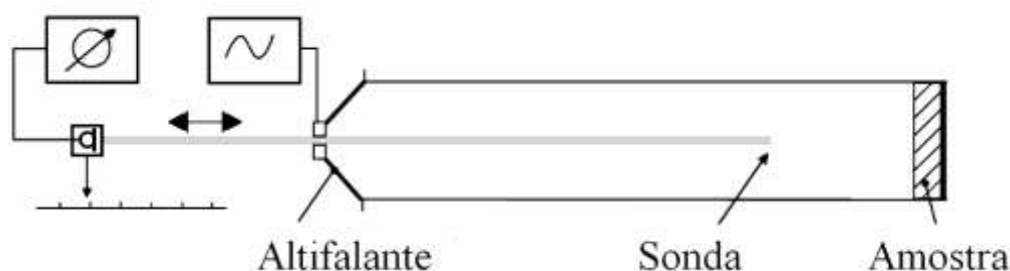
Fig. 2.13 – Representação esquemática do tubo de ondas estacionárias (Adaptado de [18])
